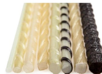
Příklady kompozitní tyčové výztuže - převzato z webu www.kompozitnityce.cz Examples of composite bar reinforcement - taken from www.kompozitnityce.cz
