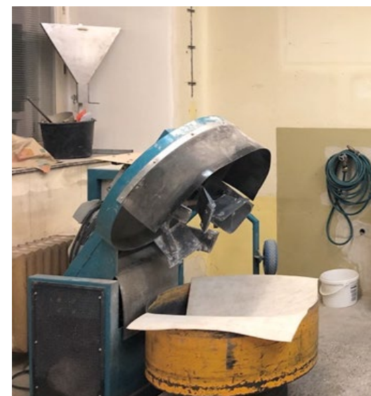
Míchací zařízení využívané v rámci vývoje cementové směsi, vlevo s maximální kapacitou 60 litrů, vpravo s kapacitou 200 litrů
