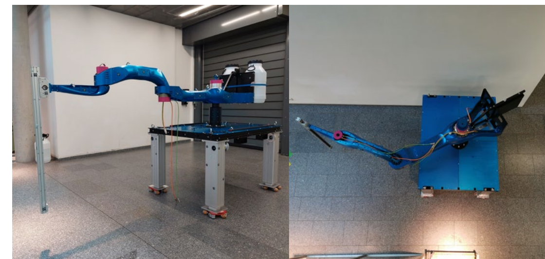
Fotografie experimentálního robotického ramene pro 3D tisk cementových směsí v měřítku 1:2 Photograph of the experimental robotic arm for 3D printing of cement mixtures in 1:2
