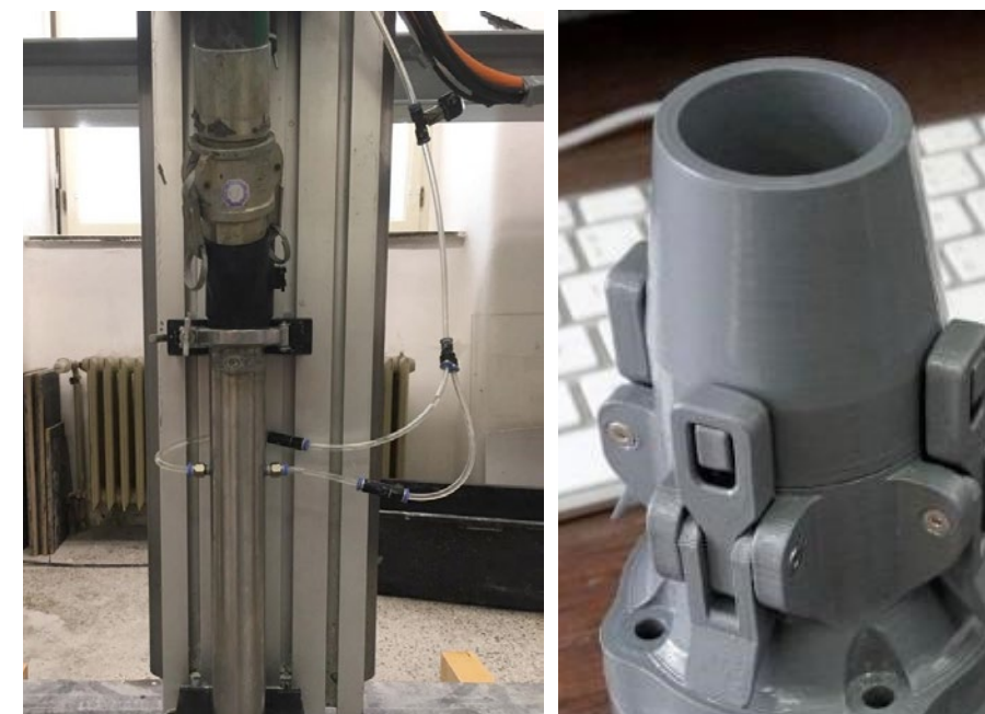
Aktuálně používaná tisková hlava se vstřikováním urychlovače tuhnutí, rychloupínací systém Currently used print head with solidification accelerator injection and quick clamping system
