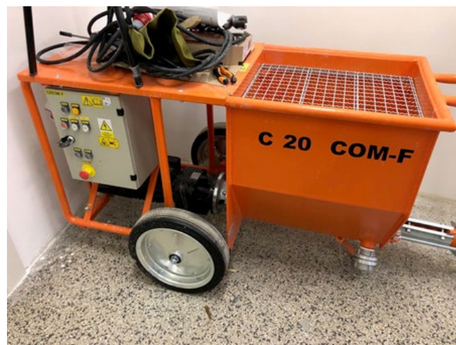
Čerpadlo betonové směsi s frekvenčním měničem Concrete mixing pump with frequency converter
