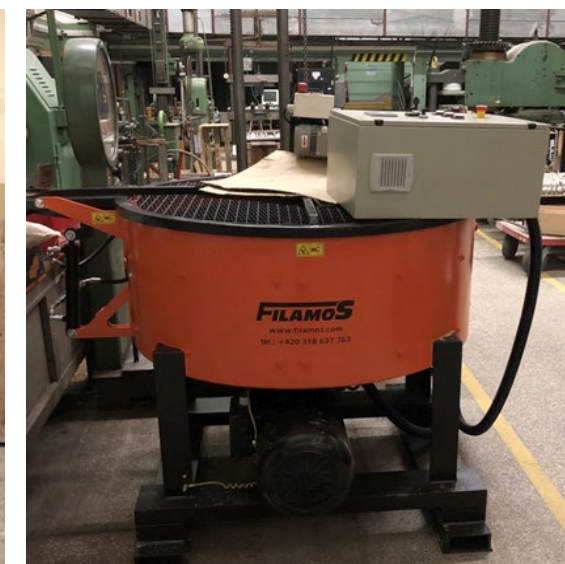
Míchací zařízení využívané v rámci vývoje cementové směsi, vlevo s maximální kapacitou 60 litrů, vpravo s kapacitou 200 litrů
