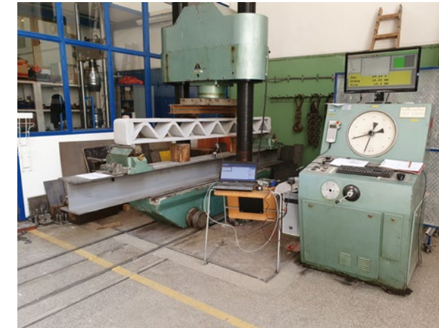
Zatěžovací zkouška příhradového nosníku v laboratoři Load test of a truss beam in the laboratory
