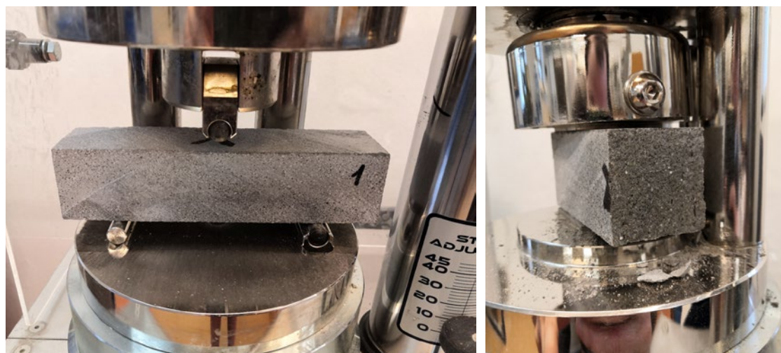
Zkoušky trámečků v tahu za ohybu (vlevo) a v tlaku (vpravo) Tests of beams in tension after bending (left) and in compression (right)
