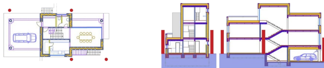
Možná umístění reflexních bodů v Trial House 1 Possible locations of reflective markers in Trial House 1
