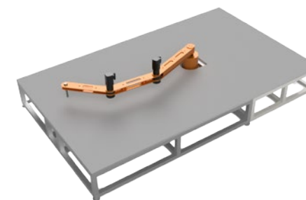
Konstrukce experimentálního robotického ramene v měřítku 1:4 (vlevo) Fotografie výroby experimentálního robotického ramene v měřítku 1:4 (vpravo) Construction of the experimental robotic arm in 1:4 (left) Photograph from the making of the 1:4 experimental robotic arm (right)
