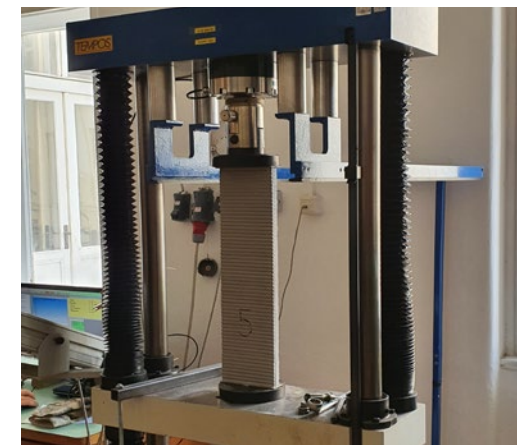
Zkoušení únosnosti vzorku tištěné stěny ve vzpěrném tlaku Testing of the bearing capacity of the printed wall sample in buckling pressure
