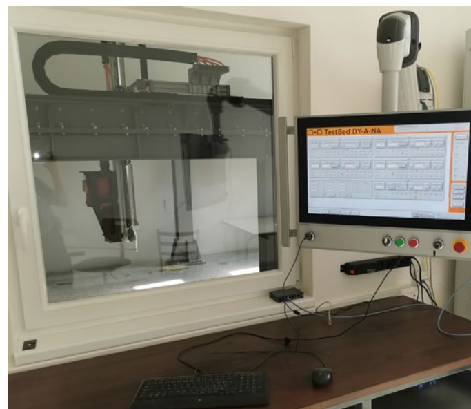
Ovládací panel s HMI rozhraním pro obsluhu TestBedu Control panel with HMI interface for operating TestBed
