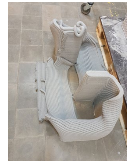
Stěnový prvek zkolabovaný při tisku v důsledku poruchy dávkování urychlovače tuhnutí směsi A wall element collapsed during printing due to a batching failure of the mixture set accelerator
