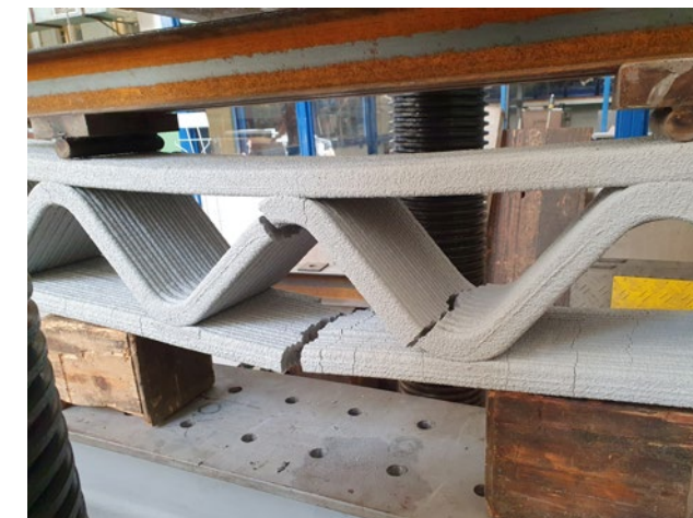
Detail porušení prvku přetržením výztuže spodního pasu Detail of element failure when reinforcement of the lower chord broke
