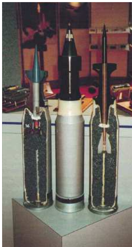
▲ Pro americké tanky M1 ABRAMS byly vyvinuty náboje M830, jejichž střela je charakterizována jako víceúčelová taktická střela, která v sobě slučuje vlastnosti podkaliberních, kumulativních i klasických tříštivotrhavých střel. Zavedením této munice se zjednodušila do jisté míry logistika tankových jednotek pozemního vojska americké armády, neboť tyto náboje mohou být použity jak proti měkkým cílům, tak vrtulníkům a bojovým vozidlům včetně tanků.
