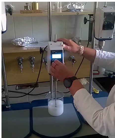
Obr. 5. Vzhled finální násobné emulze při odpařování rozpouštědla (Foto: J. Vysloužil).
