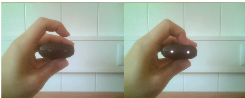
Obr. 7. Digitální fotoaparát snímá i v oblasti blízké infračervené (viz graf spektrální citlivosti CCD čipu na obr. 6 dole), což se většinou (nedostatečně) řeší pomocí filtrů na optické cestě. Situaci lze snadno demonstrovat – pomocí webové kamery je možné „vidět“ např. signál dálkového ovladače k datovému projektoru (vlevo bez signálu, vpravo se signálem).
