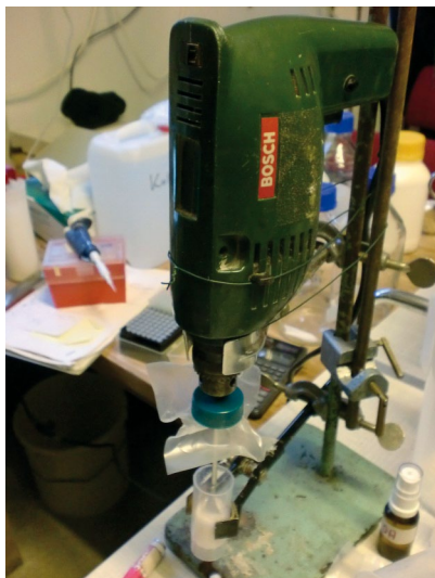
Obr. 15. Pro vmíchání GnRH do emulze FIA lze v nouzi využít elektrickou vrtačku. Jako nádoby pro míchání využijeme zkumavek z tvrdého PVC. Ty musí být upraveny (seřiznuty) tak, aby se injekční stříkačkou dosáhlo až na dno zkumavky. Při míchání vrtačkou je nutno zkumavku utěsnit víčkem s parafínem. Foto: Viktor Švinger a Dennis Kallert.
