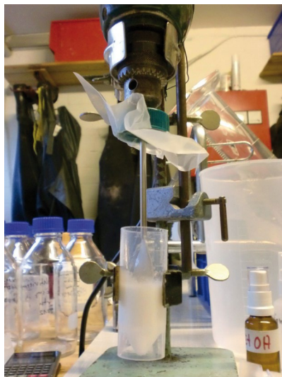
Obr. 15. Pro vmíchání GnRH do emulze FIA lze v nouzi využít elektrickou vrtačku. Jako nádoby pro míchání využijeme zkumavek z tvrdého PVC. Ty musí být upraveny (seřiznuty) tak, aby se injekční stříkačkou dosáhlo až na dno zkumavky. Při míchání vrtačkou je nutno zkumavku utěsnit víčkem s parafínem. Foto: Viktor Švinger a Dennis Kallert.
