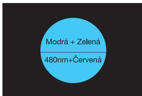
OBR. 19 Přídavek primárního červeného světla způsobí snížení čistoty monochromatického světla 480 nm a dojde k vyrovnání barev
