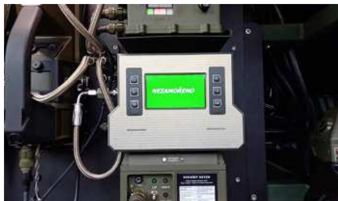
Vysoce citlivý detektor nervově paralytických látek DAPH
