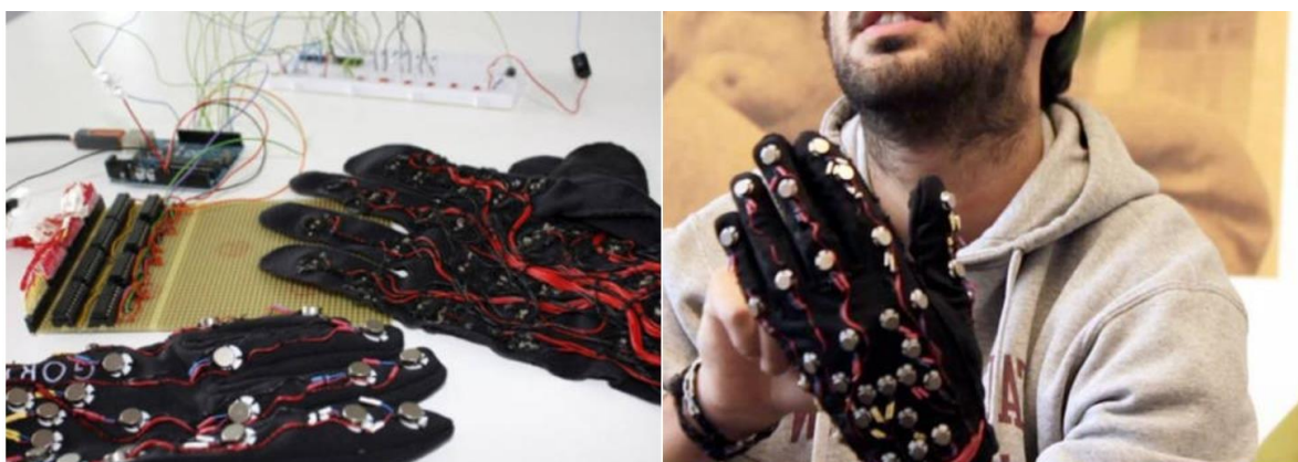
Obrázek 6: Speciální rukavice pro jedince s hluchoslepotou využívající princip Lormovy abecedy (Tiché zprávy 2015)
