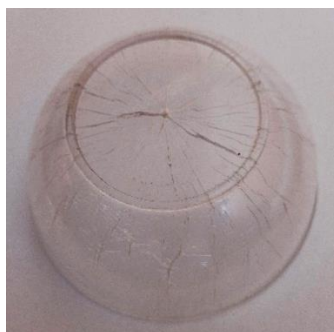
Obr. 8 Porušení dílu v oblasti vtoku vlivem vnitřního pnutí
