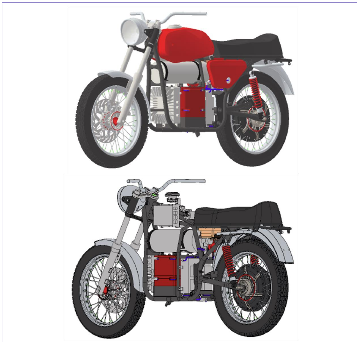
Figure 2: 3D model konceptu motocyklu, Pohled na rozložení jednotlivých komponent hnacího ústrojí [1]
