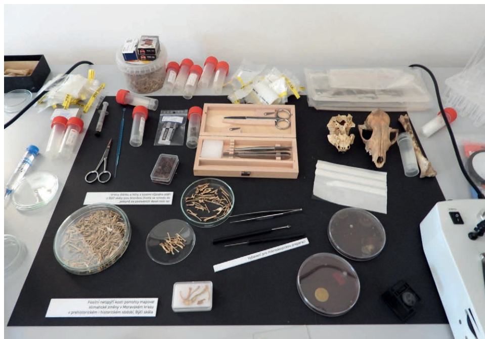
Obr. 61: Na laboratorním stole jsou na černé podložce umístěné jednorázové nádoby (sputovky), pinzety, nůžky a další příslušenství potřebné k práci s mikroskopem. Současně jsou ve skleněných Petriho miskách různé velikosti umístěny fosilní kosti netopýrů, které umožnily matovat klimatické změny v Moravském krasu (Býčí skála) v prehistorickém a historickém období. Vpravo jsou umístěny lebky různých savců. V obdélníkové krabici jsou vrstvy štěrku a hlíny s kostmi různého stáří z Býčí skály. Jsou kronikou života ve vchodu do jeskyně za posledních asi 10 tis. let (foto I. Pavlík).
