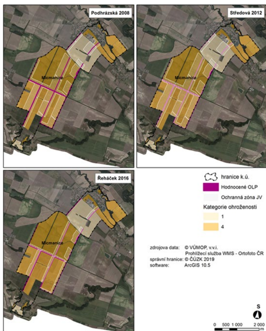
Obr. 31 Příklad modelování ochranných zón pro převládající směr větru jihovýchodní
