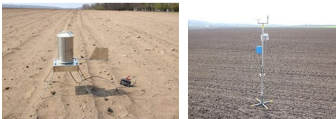
Obr. 59 Fotografie deflametru (vlevo) a fotografie mobilní meteostanice (vpravo)
