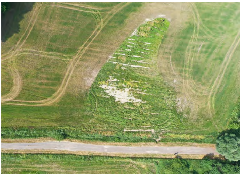
Obrázek č. 66: Příklad rozpadajícího se drenážního systému znemožňujícího obdělávání plochy na snímku z dronu v katastru Špičky
