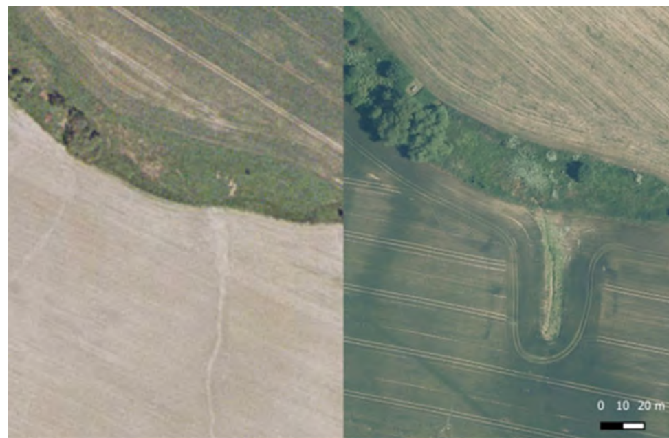
Obrázek č. 61: Místo s rozpadajícím se sběrným potrubím. Vlevo je rok 2006, vpravo rok 2022. (Podkladová data: Prohlížeč služba WMS – Ortofoto, ČÚZK, 2023)
