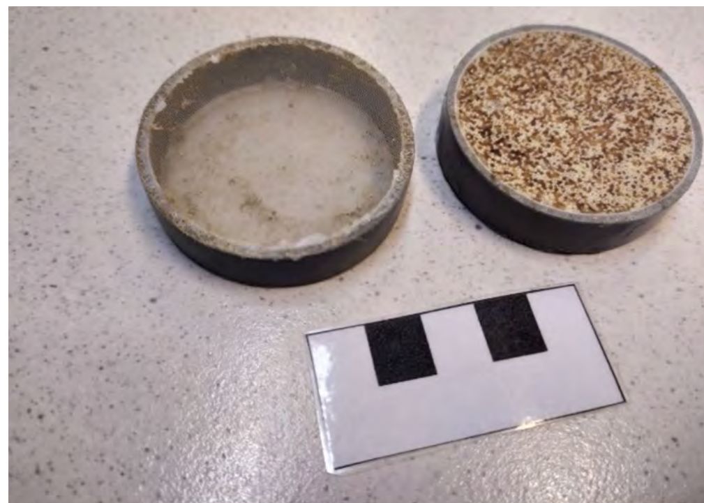
Obrázek č. 7: Ukázka iontoměniče – vlevo prázdný obal, vpravo obal s ionexem, který bude později analyzován (měřítko v centimetrech)
