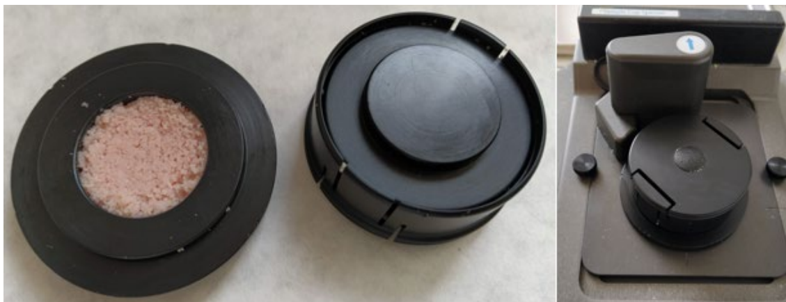
Obrázek 1: Kompresní kyveta naplněná homogenizovaným vzorkem šunky, uzavřená kompresní kyveta na spinneru
