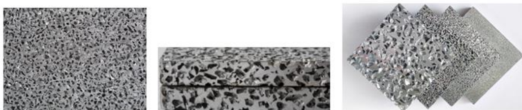
Obr. 2.20c) Struktura porézního hliníkového materiálů vyrobených na bázi Al-NaCl, (vyrobena firmou Alumeco Group a Exxcentis), [17]
