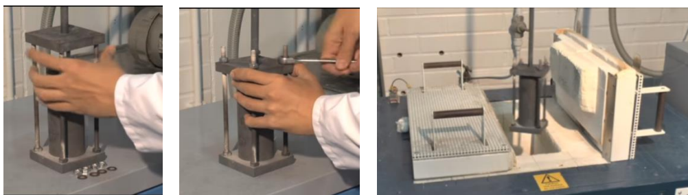
Obr. 2.13 Sestavení horní příruby a sevření 4 šrouby, vkládání formy do pece, [15]
