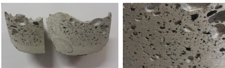
Obr. 7.60 Pohled na řez vzorkem 2 ze slitiny AlSi7Mg0,, vlevo a jeho napěněnou část (napěněný vzorek Ø 118 mm; maximální výška 80 mm), vpravo, vzorek č. 2
