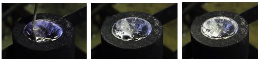
Obr. 2.4a) Výroba porézního hliníku, v okamžiku sypání soli do formy a s následnou impregnací soli taveninou hliníku pro vznik kompozitního systému Al-NaCl, ALUPOR
