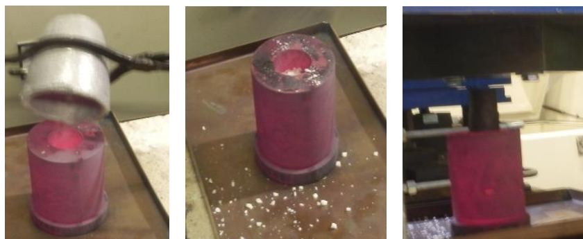
Obr. 7.19 Plnění slévárenské formy taveninou (vlevo); slévárenská forma s taveninou a nasypanou solí do dutiny formy a pohled na formu a na pracovní části hydraulického lisu (vpravo)
