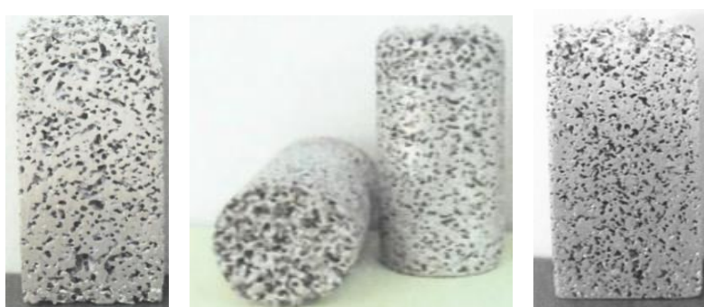
vyrobený vzorek s použitím částic NaCl s velikostí 0.6 mm (vlevo) vyrobený vzorek s použitím částic NaCl s velikostí částic 0.3 mm (vpravo)
