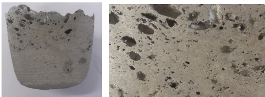
Obr. 7.66 Řez vyrobeným napěněným vzorkem ( \varnothing 125 mm; \varnothing 85 mm; maximální výška 105 mm), vlevo a půdorysný pohled na napěněnou část vzorku z materiálu AlSi5Mg (řez o ploše 50 x 75 mm), vpravo
