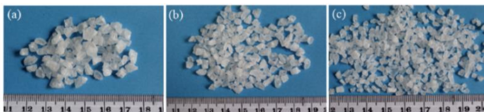
Obr. 2.38 Pohled na použité velikosti částic NaCl pro výrobu porézních hliníkových systémů (hliníkových „pěn“): a) velikost částic NaCl od 4,7 do 4,0 mm; b) velikost částic NaCl od 4,0 do 3,3 mm; a c) NaCl velikost částic 3,3 až 2,0 mm [27]
