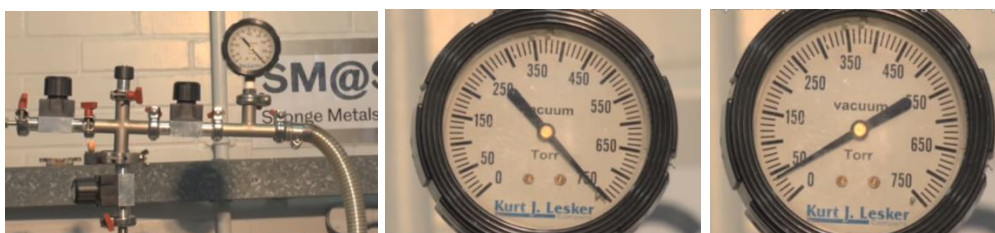
Obr. 2.16 Rozvodný T systém, ústící do formy; zapnutí vývěvy a vytvoření vakua až se dostane ručička manometru na hodnotu „0“
