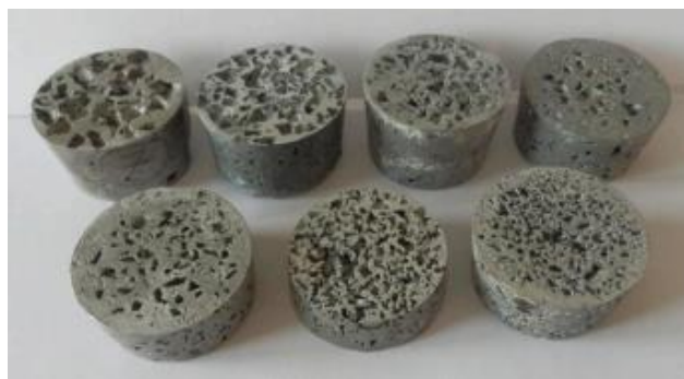
Obr. 7.21 Pohled na vyrobené vzorky hliníkového porézního materiálu, slitina AlSi12, perspektivní pohled, (vzorky č: 1,2,3,4,5,6, a 7)
