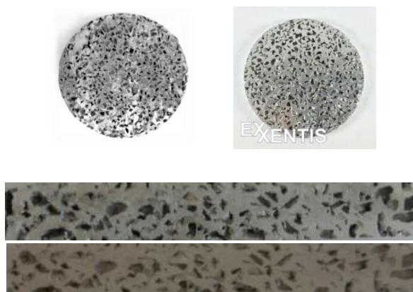
Obr. 7.12 Makrostruktura porézního vzorku ze slitiny hliníku AlSi 12, \varnothing 60 \times 10 mm, vlevo; řez slitinou hliníku vyrobenou společností EXXENTIS, vpravo; příčný řez vyrobeným vzorkem, dole
