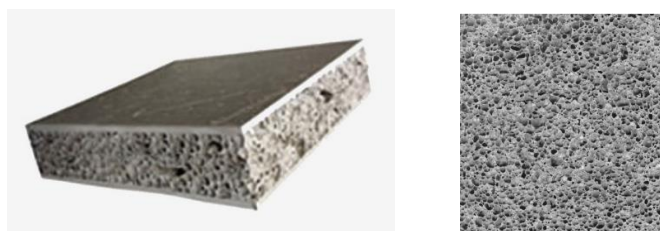
Obr. 4.11 Kovová pěna (kovový celulární systém), při jejíž výrobě bylo použito napěňovací činidlo ZrH 2 (vlevo); pórovitá struktura hliníkové pěny vyrobená s použitím TiH 2 , zobrazená plocha má rozměr 80 x 80 mm (vpravo), Univerzita Nanjing, jihovýchodní Čína
