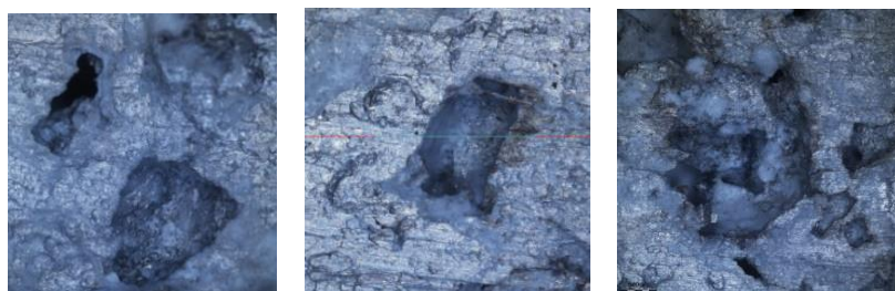
Obr. 7.13 Řez vyrobeným porézním materiálem z hliníkové slitiny AlSi 12, sledováno mikroskopem Olympus DSX 500, zvětšeno 10 násobné
