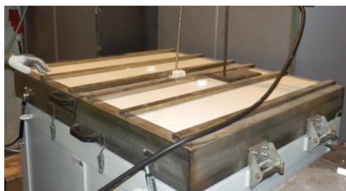
Obr. 7.51b) Pohled na napěňovací pec krabicového tvaru firmy HTM Reetz GmbH a přívod napěňovacího média do taveniny kov
