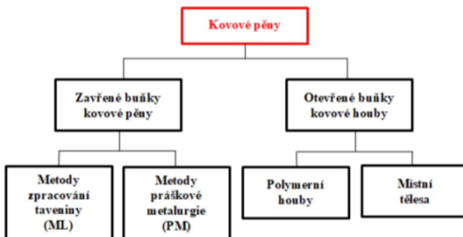
Obr. 4 Rozdělení kovových celulárních materiálů (kovových pěn) podle GARCIA-MORENA [10]
