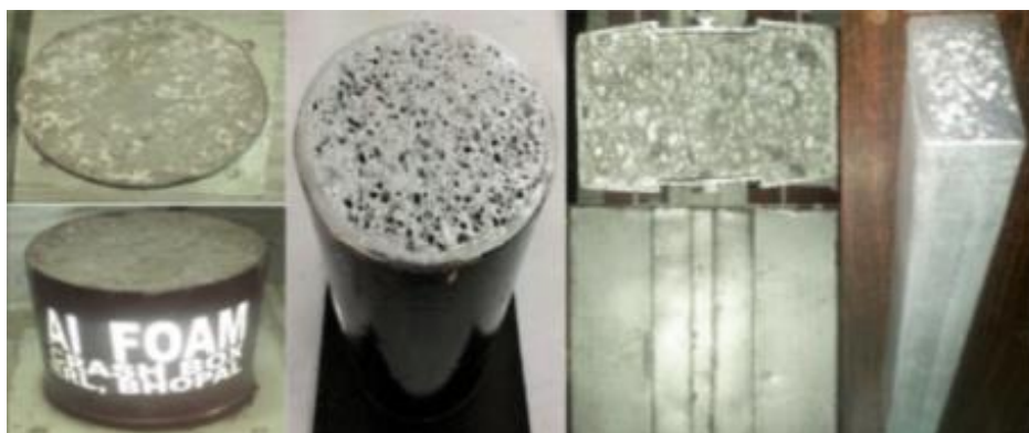
Obr. 1.29 Trubky a další profily s hliníkovou pěnou vyrobené na Advanced Materials and Process Research Institute (AMPRI) Bhopal, Indie [54]
