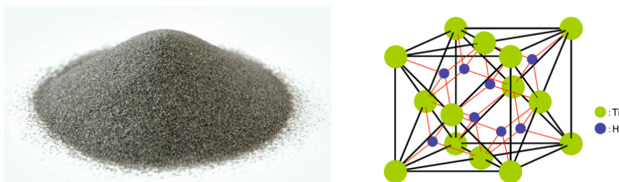
Obr. 4.3 Hydrid titanu, velmi reaktivní chemická sloučenina (teplota tání 450 °C, hustota = 3760 kg·m -3 , molární hmotnost 49,91 g·mol -1 ), kubická krystalická mřížka FCC TiH 2 s tetrahedrickým uložením atomů vodíku [20]
