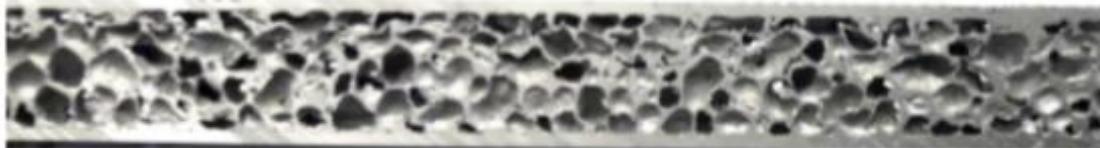
Obr. 1.28b) Struktura sendvičového panelu AFS, tloušťka cca 10 mm, při zachování všech parametrů správném výrobním procesu [54]
