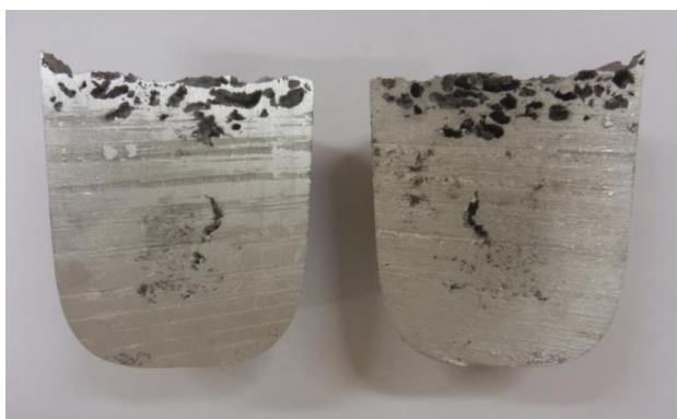
Obr. 7.55 Pohled na plochy řezu napěněného vzorku \varnothing 52 mm, výška 56 mm, napěňování vrstva vzorku cca 10 mm, doba napěňování 15 minut, argon; vzorek č. 1
