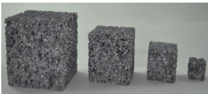
Obr. 1.10c) Řez hliníkovou pěnou ALPORAS (1,5 hmot. % Ca; 1.6 hmot. % napěňovacího činidla TiH_2 ) [18]
