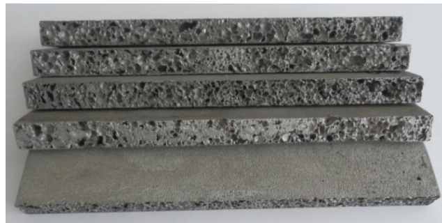
Obr. 1.25 e) Hliníkové pěny s povrchovou krustou, vyrobeno na základě práškové technologie (prášek AlSi12 a TiH 2 ), rozměr 150 x 50 x 10 mm, [55]
