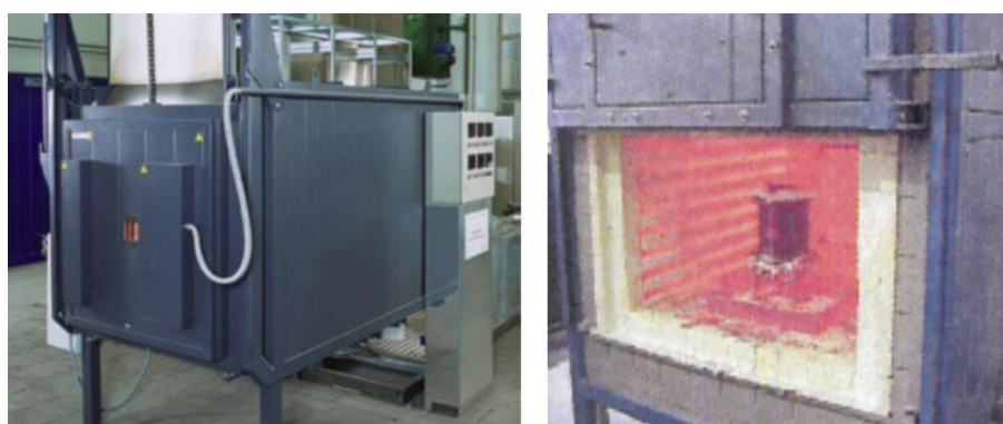
Obr. 1.25c) Odporová elektrická pec pro realizaci napěňovacího procesu hliníkových polotovarů vyrobených práškovou metalurgií (firma LKR), [55]
