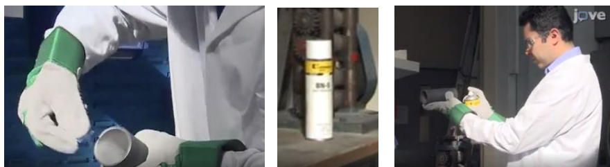
Obr. 2.11 Ošetření dutiny formy před technologickým procesem výroby porézního systému, LUNA, [15]
