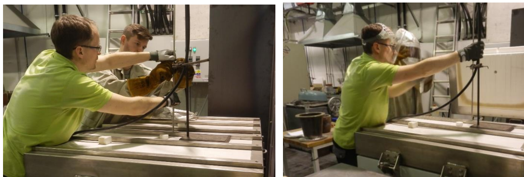
Obr. 7.52 Příprava napěňovacího procesu a pohled na zavádění napěňovacího čidla do taveniny hliníku, dr. Sobotka dr. Koreček
