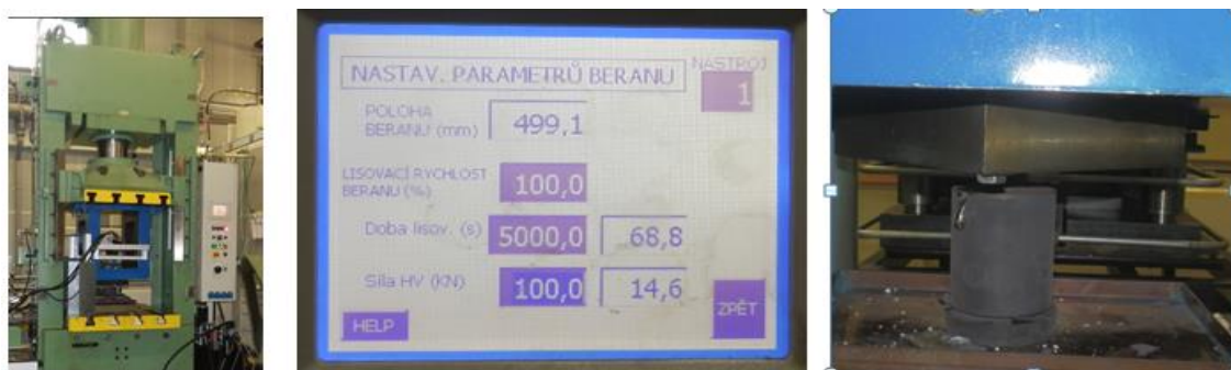
Obr. 7.20 Pohled na hydraulický lis a na jeho monitor s nastavením potřebných hodnot lisovacích parametrů
