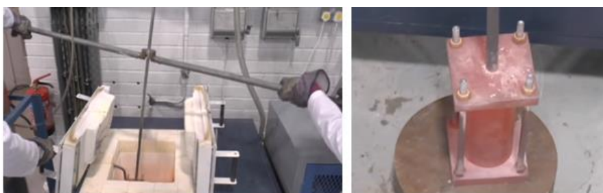
Obr. 2.17 Pohled na otevřenou pec, při vyjímání formy speciálním přípravkem (vlevo), výtmutá forma (vpravo), [15]
