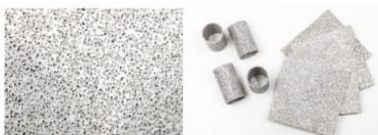
Obr. 2.21 Výrobky z porézního hliníkového materiálu s částicemi soli propagovaného firmou Material Distric, Narden, [19]
