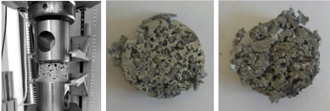
Obr. 7.38 Měření pevnosti vzorků na zařízení TIRA Test a vzorky po zkoušce v tlaku
