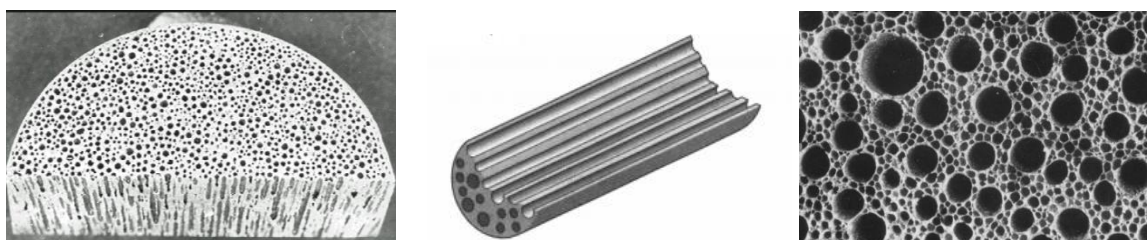
Obr. 1.17 Celulární kovový systém vyrobený metodou Gasar, obsahuje převážně podlouhlé póry (buňky), podle V. Shapovalova, jak je uvedeno [1]
