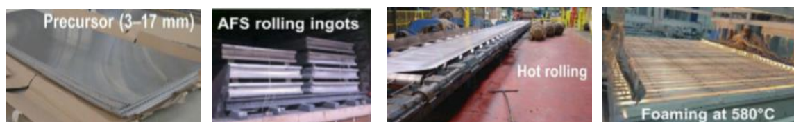
AFS rolling ingots – AFS válcované ingoty, Hot rolling – válcování za tepla, precursor (3-17 mm) – polotovary (3-17mm), Foaming at 580\text{ }^\circ\text{C} – napěňování při teplotě 580\text{ }^\circ\text{C}
