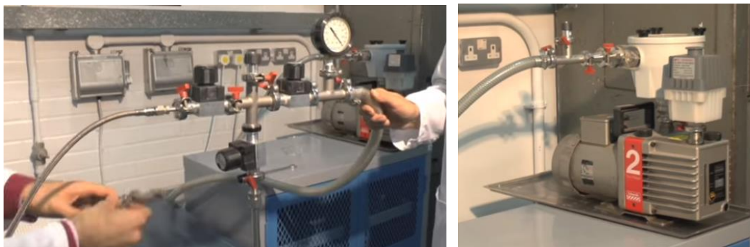
Obr. 2.15 Pohled na vakuový systém pro odsátí vzduch ze smontované formy
