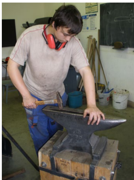
Ruční rovnání materiálu kladivem na dráze kovadliny
