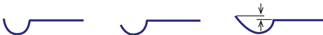
Správné a dvakrát chybné provedení vroubku
