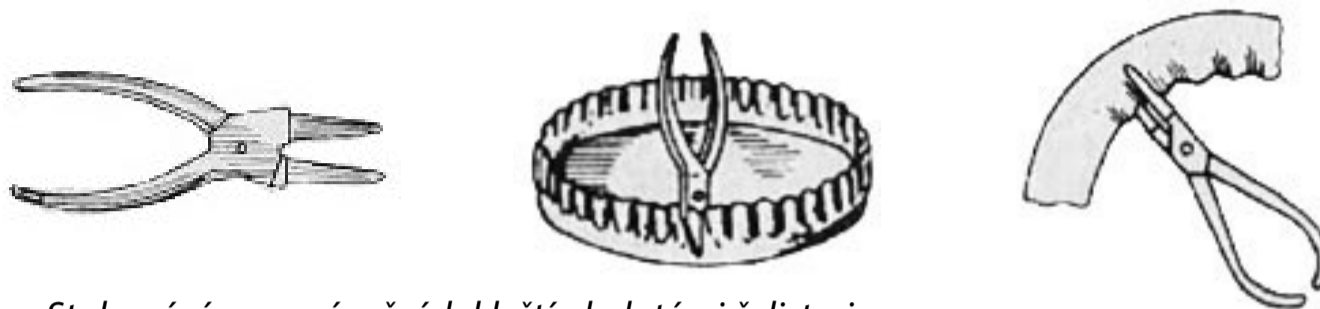
Stahování pomocí ručních kleští s kulatými čelistmi
