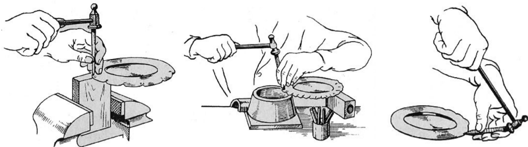
Různé způsoby cizelování okraje ozdobné nádoby
