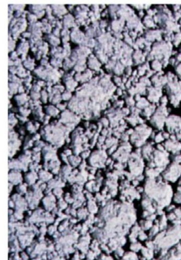
stejnozrnný propustný beton
