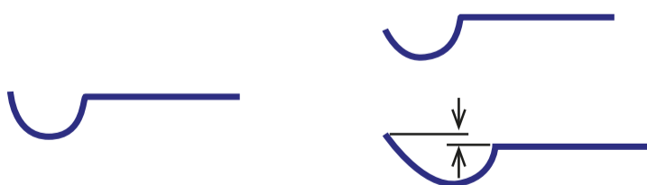
Správné a 2x chybné provedení vroubku
