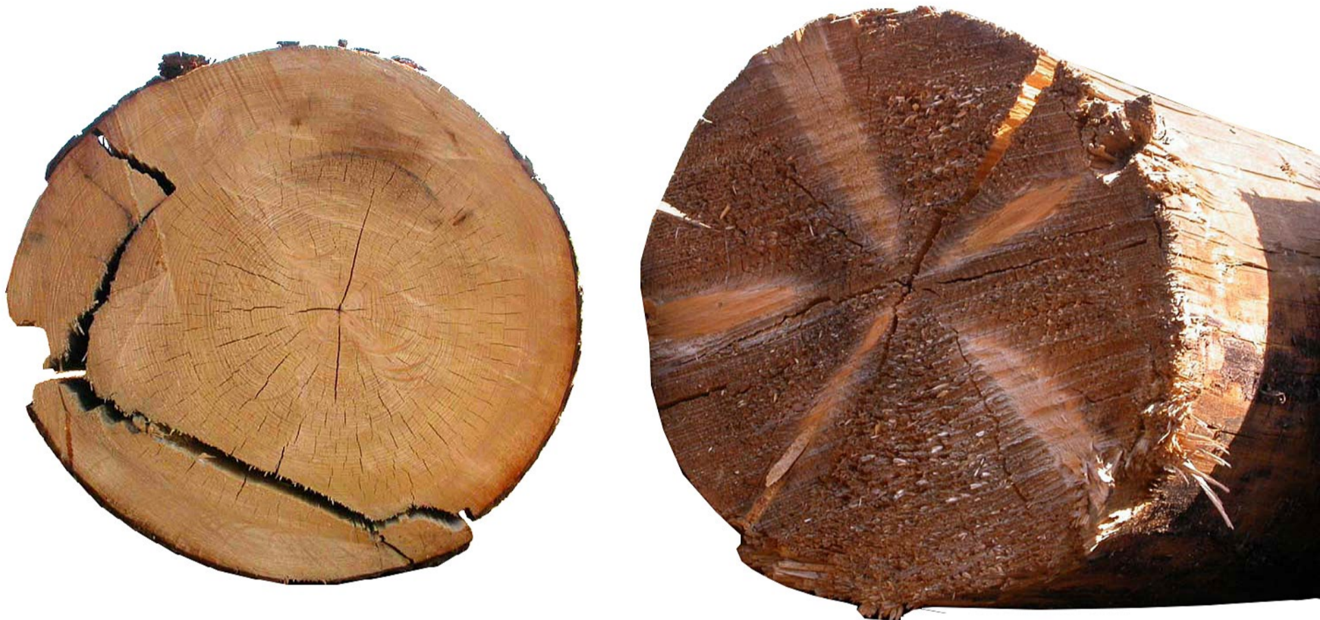
Vady dřeva: trhliny, suky
