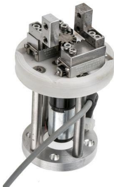
Obr. 4.25 Chapadla s elektrickým pohonem, zdroj: https://cz.rs-online.com/web/
