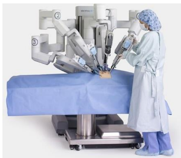
Obr. 7.7 Servisní robot pro zdravotnictví – chirurgický robot Da Vinci
