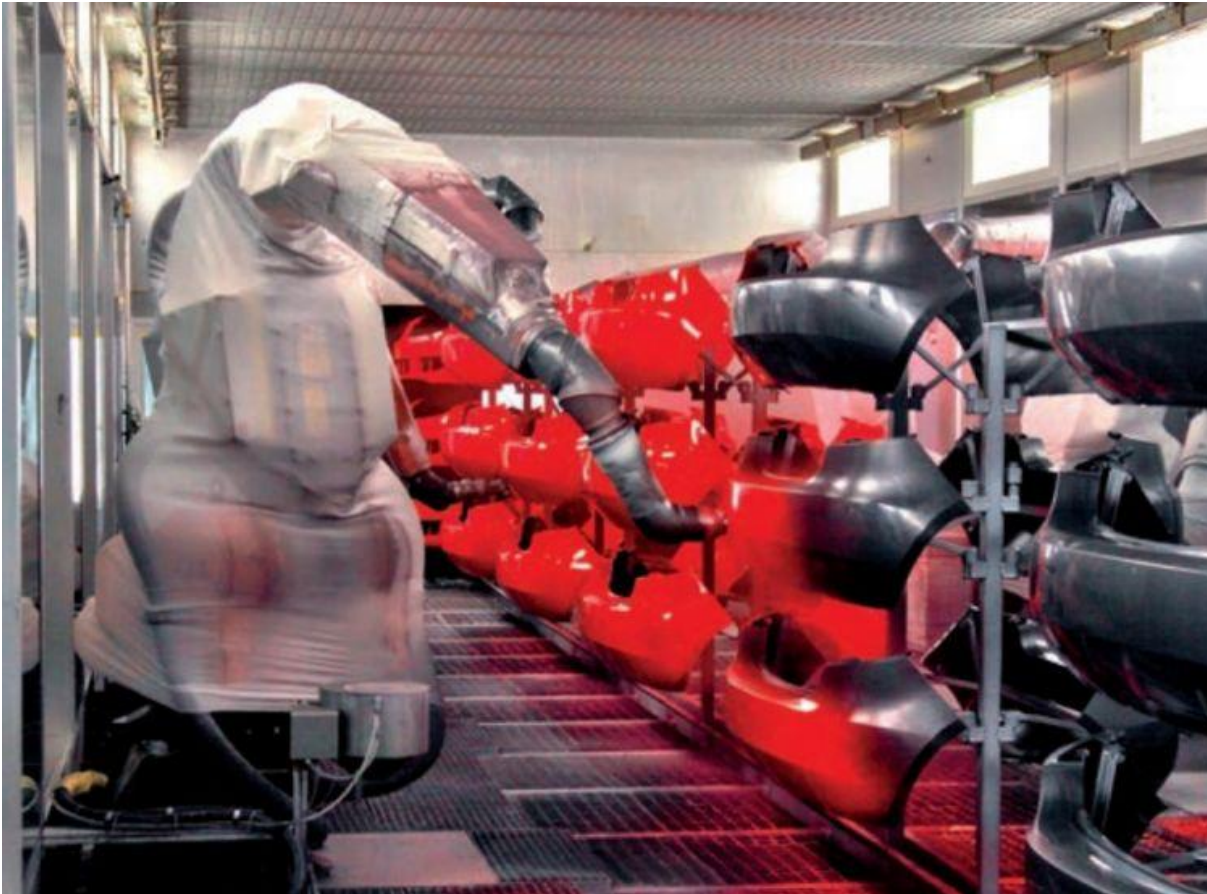
Obr. 6.6 Stříkání plastových nárazníků robotem (firma Magna)
