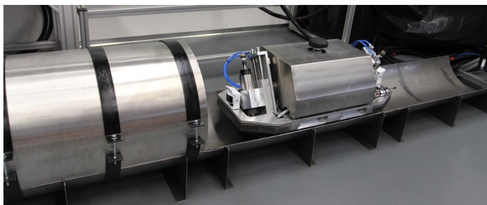
Obr. 7.13 Robot pro inspekci a odebrání kontaminovaných vzorků z primárního potrubí vyřazovaného jaderného reaktoru
