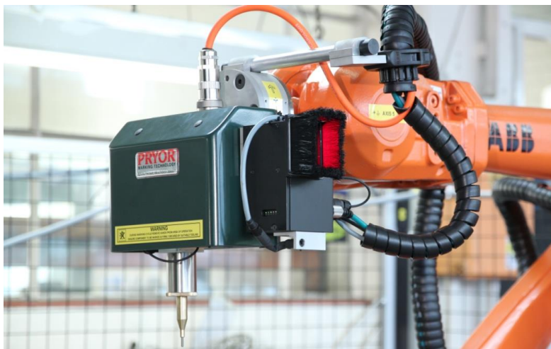
Obr. 4.11 Kombinovaná hlavice pro značení a čtení textu/kódů pomocí integrované kamery, zdroj: https://www.pryormarking.com/products/robotic-marking-cell
