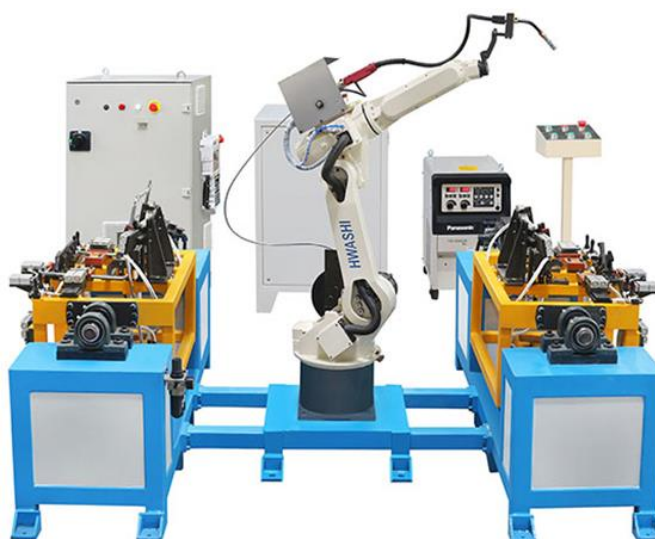
Obr. 6.4 RTP pro obloukové svařování pod ochrannou atmosférou s polohovadly obrobků
