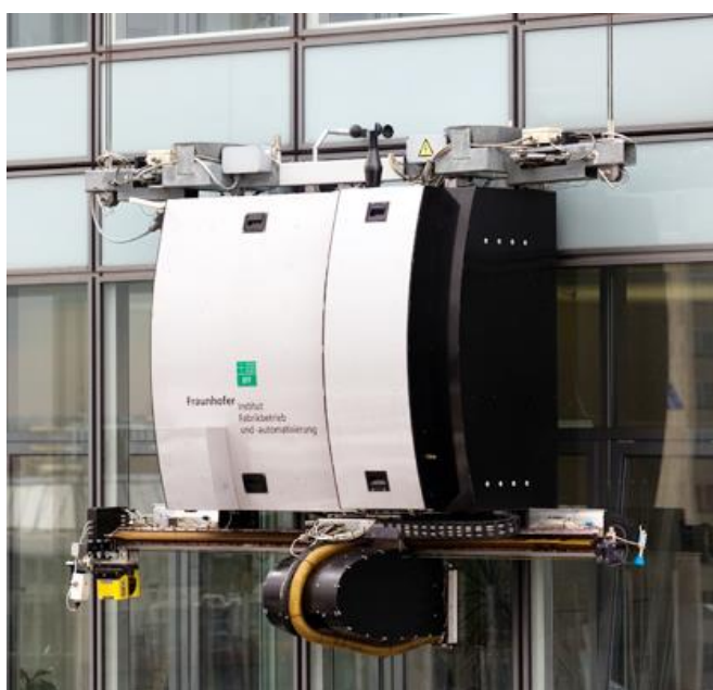
Obr. 7.12 Roboty pro práci na vertikálních stěnách (kontrola a čištění)
