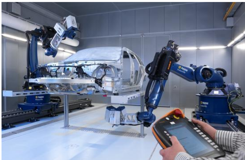
Obr. 4.12 Automatická měřicí stanice vybavená 3D skenovacím vibrometrem RoboVib® Structural Test Station, zdroj: https://www.polytec.com/us/vibrometry/products/full-field-vibrometers/robovib/
