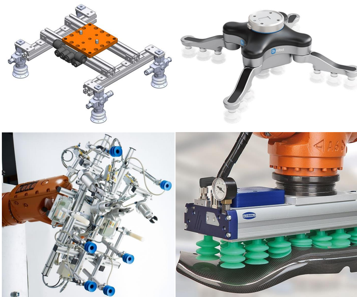
Obr. 4.31 Ukázky aktivních podtlakových úchopných hlavic, zdroj: http://www.onexiarobotics.com , https://www.plasticmachinerymagazine.com/blow-molding/ , https://e oat.net/tooling/ , https://www.schmalz.com
