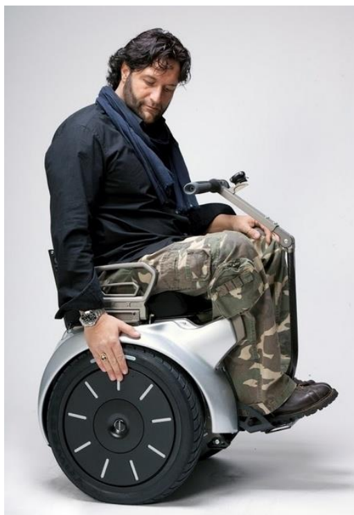
Obr. 7.6 Servisní robot jako vozík pro invalidy, zdroj: https://www.gennymobility.com
