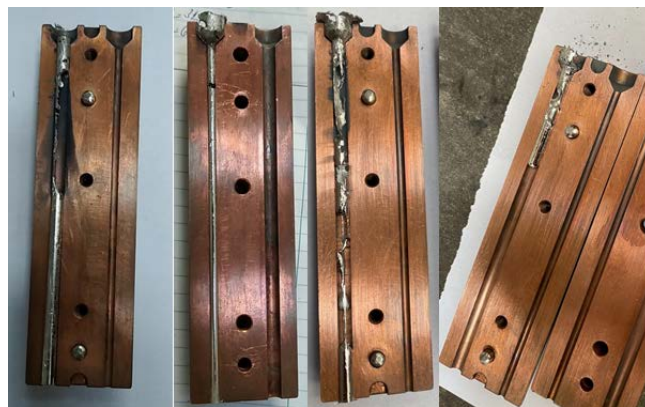
Obr. 2 Odliate vzorky Mg_{66}Ca_{30}Zn_4
