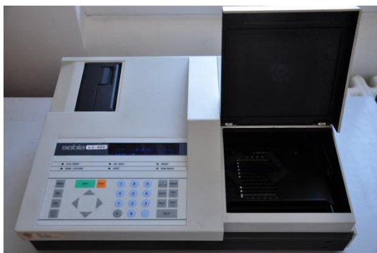
Elektroforetické zařízení pro separaci proteinů, upevnění gelu, výsledek
