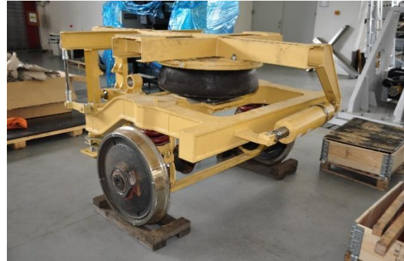
Obr. 13: Pohled na funkční vzorek jednonápravového podvozku, vlevo pohled ze strany oje, vpravo pohled ze strany vratného mechanismu
