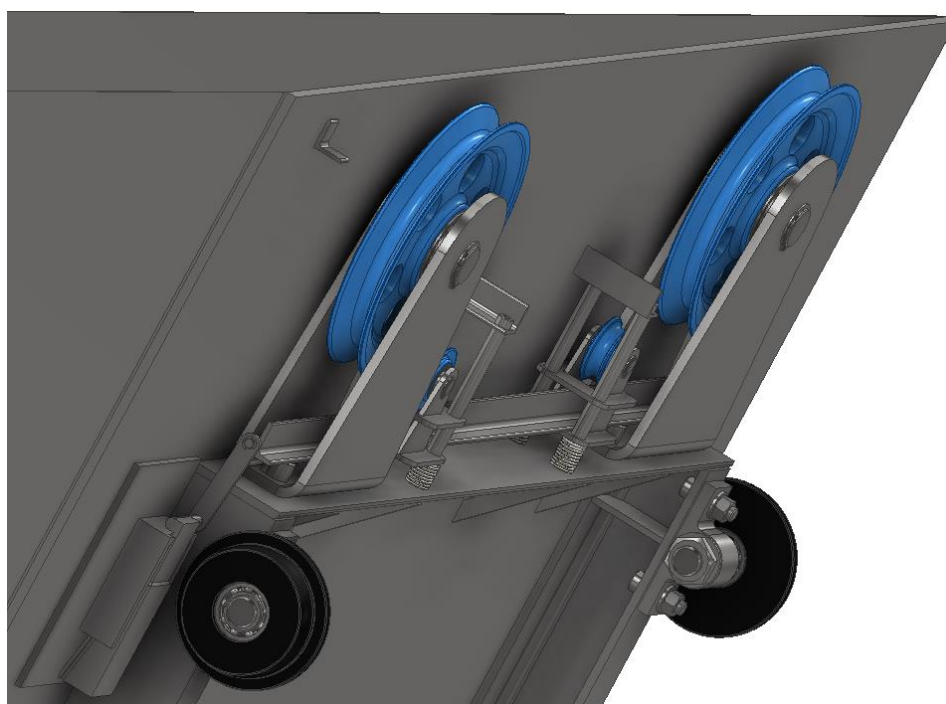
Obrázek 2: Zachycovací mechanismus v poloze při napnutém lanu
