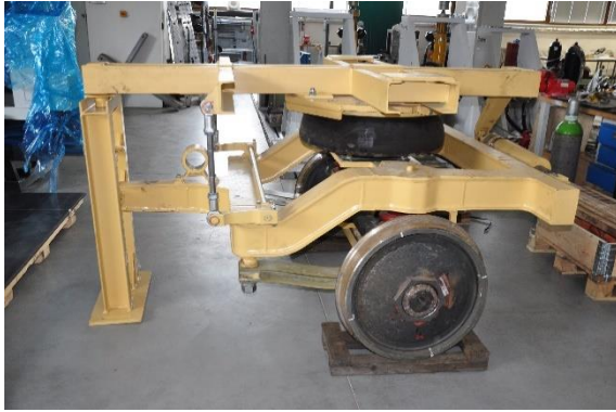
Obr. 13: Pohled na funkční vzorek jednonápravového podvozku, vlevo pohled ze strany oje, vpravo pohled ze strany vratného mechanismu
