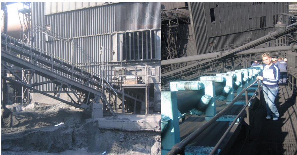
Obrázok 1: Pôvodný klasický a nový potrubný dopravník na prepravu praženca
