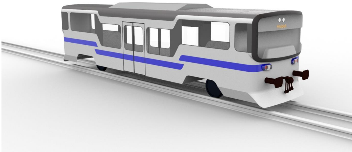
Obr.17: Studie dvounápravového motorového vozu s otočnými podvozky (Mgr.Pelikán)
