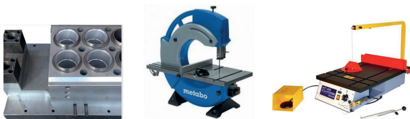
Obr. 8.4 Příklady ořezu vytvarovaného dílu
