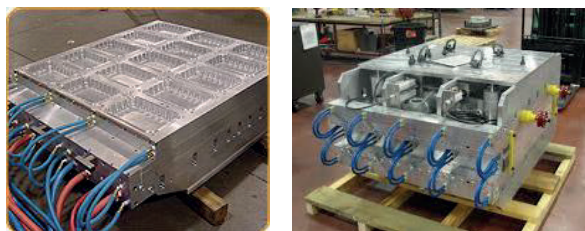
Obr. 8.3 Příklad hliníkových forem s propojenými chladicími (temperačními) kanály
