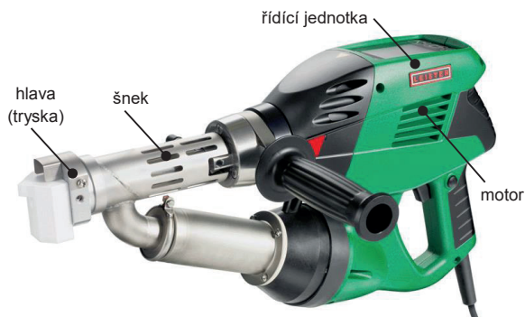
Obr. 9.22 Extruzní svařovací pistole
