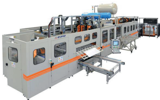
Obr. 8.6 Plně automatický tvarovací stroj (kontinuální výrobní linka)
