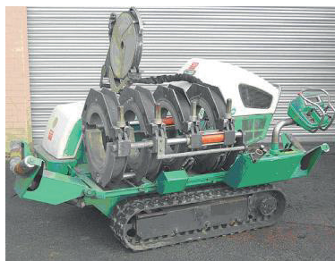
Obr. 9.4 Poloautomatické zařízení pro svařování na tupo
