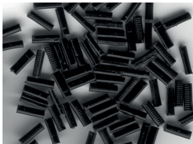
Obr. 4.10 Granulát polymeru s dlouhými skleněnými vlákny (LGF)
