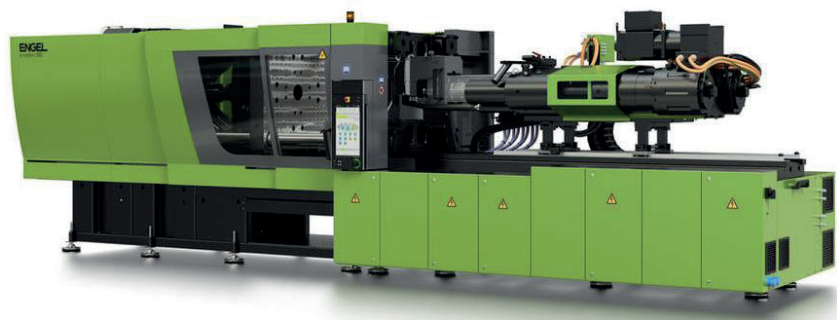
Obr. 4.19 Příklad stroje pro sendvičové vstřikování
