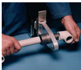
Obr. 9.8 Ruční způsob polyfúzního svařování
