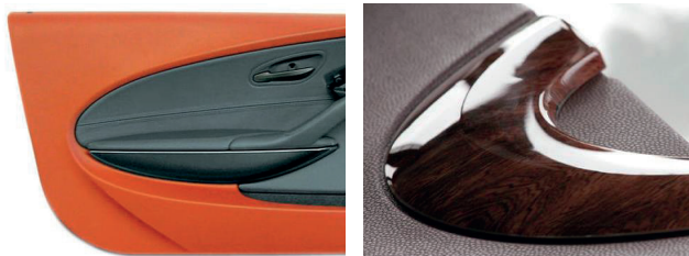
Obr. 4.52 Příkladů pastových dílů vyráběných technologií zastříkování
