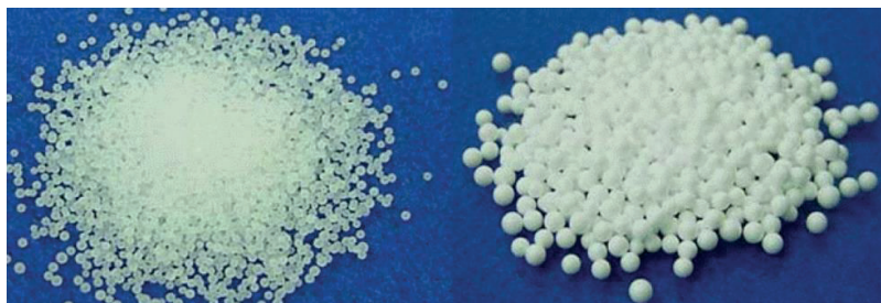
Obr. 4.46 Kuličky polystyrenu (vlevo) a předpěněné kuličky polystyrenu (vpravo)
