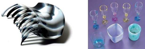
Obr. 4.28 Příkladů plastových dílů vyrobených intervalovým vstřikováním
