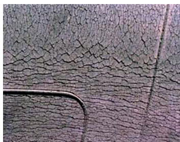
Obr. 1.17 Stárnutí pryže vlivem ozonu
