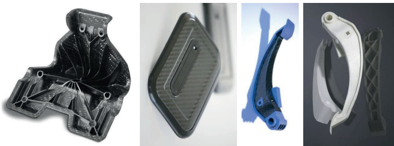
Obr. 4.54 Příkladů pastových dílů vyráběných technologií organoplechů
