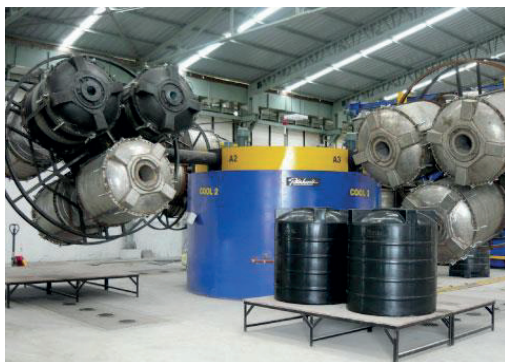
Obr. 7.3 Příklad víceosého rotačního zařízení
