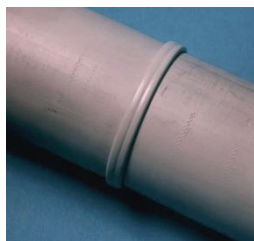
Obr. 9.6 Výronek ve svarovém spoji
