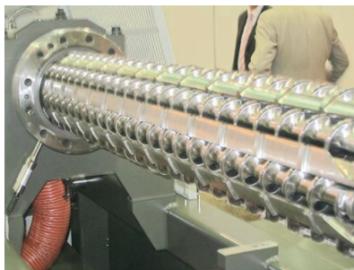
Obr. 2.4 Planetové uspořádání šneku hnětiče
