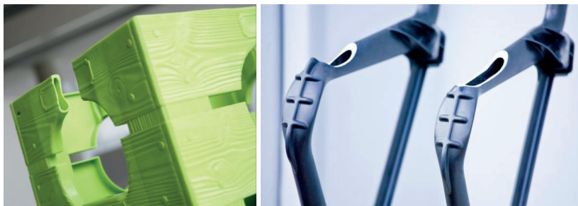
Obr. 4.11 Příklady plastových dílů vyráběných technologií vstřikování s podporou plynu
