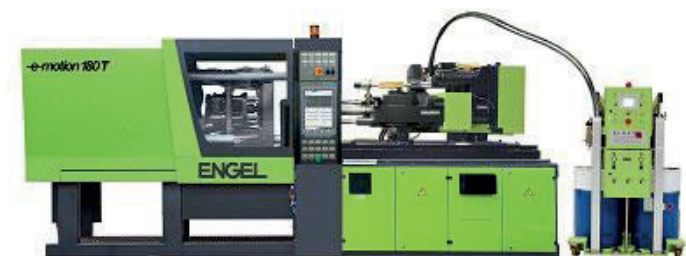
Obr. 4.8 Vstřikovací stroj pro technologii vstřikování silikonů
