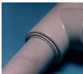
Obr. 9.9 Svarový spoj (polyfúzní svařování)
