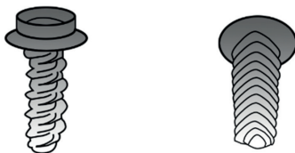
Obr. 6.27 Nekruhový průřez šroubu
