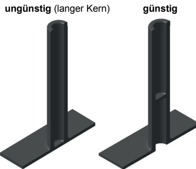
Abb. 4.17 Optimale Dimensionierung von Öffnungen
