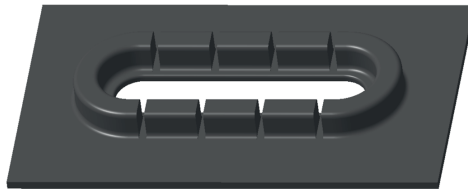
Abb. 5.29 Konstruktionsanpassung zur Minimierung der im Produkt durch Wärmeausdehnung hervorgerufenen Eigenspannung
