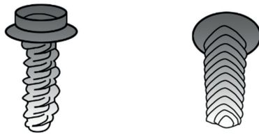
Abb. 6.27 Nicht kreisförmiger Schraubenquerschnitt
