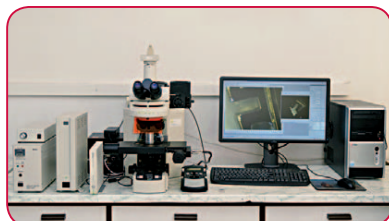
Souprava mikroskopu NIKON – měření geometrie ortodontických přípravků z inteligentních materiálů
