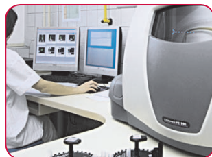
Průtokový cytometr je nenahraditelný v diagnostice poruch imunity a ve vědeckých aplikacích.
