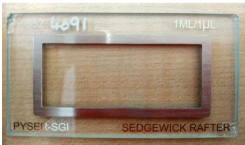
Obr. 6. Sedgewick-Rafterova počítací komůrka využívaná při zjišťování hustoty kultury vířníků (Foto: C. Yanes-Roca).
