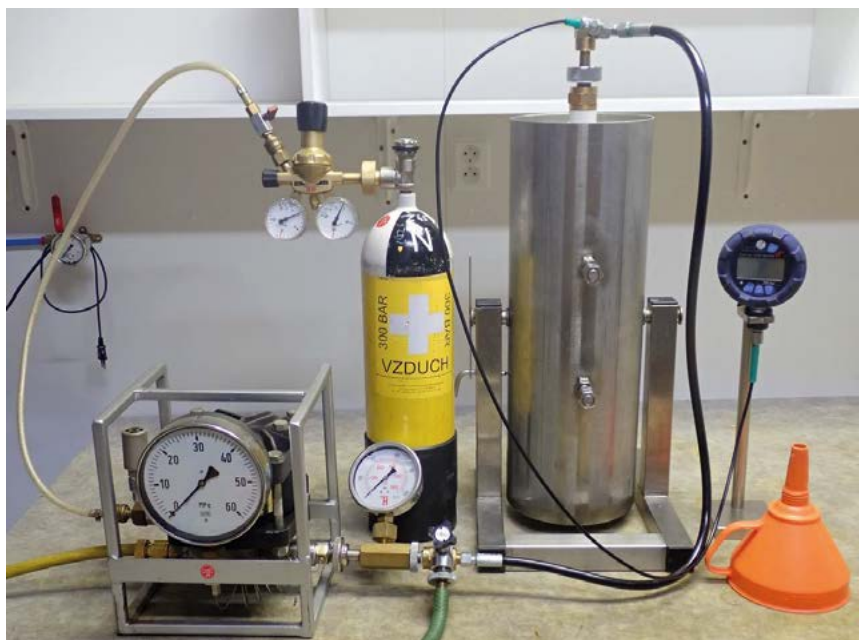
Obr. 6. Tlaková jednotka pro indukci polyploidie u ryb změnou hydrostatického tlaku (Foto: M. Flajšhans).
