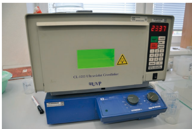
Obr. 5. UV illuminátor – crosslinker UVP CL-1000 (foto Bram Rohaan).
