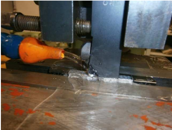
Obr. 43 Detail nástroje, obrobku a hubice pro přívod procesní kapaliny
