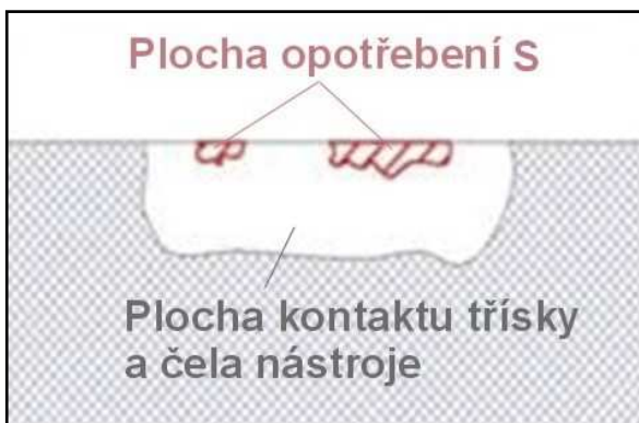
Obr. 44 Schéma dílčích ploch opotřebení na čele řezného nástroje
