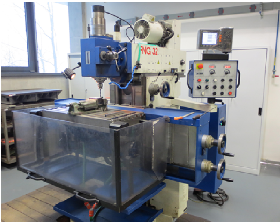
Obr. 15 Frézka FNG 32 použitá pro vrtání
