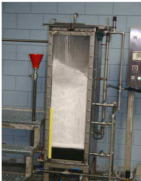
Obr. 11 Generování tlaku 200 bar v zařízení CIMCOOL HPFT Device [ 20 ]
