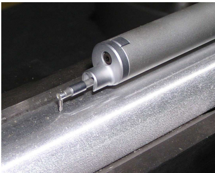
Obr. 33 Stopy nástroje na obrobeném povrchu
