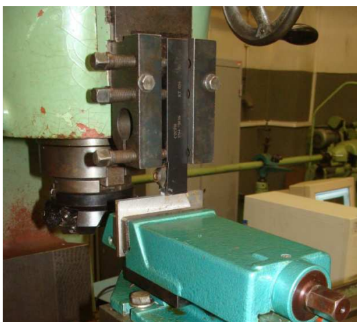
Obr. 42 Hoblovací nůž upnutý do speciálního držáku na vřeteníku stroje
