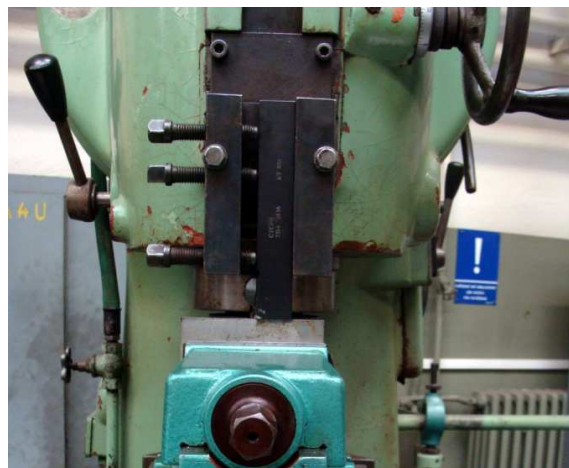
Obr. 42 Hoblovací nůž upnutý do speciálního držáku na vřeteníku stroje
