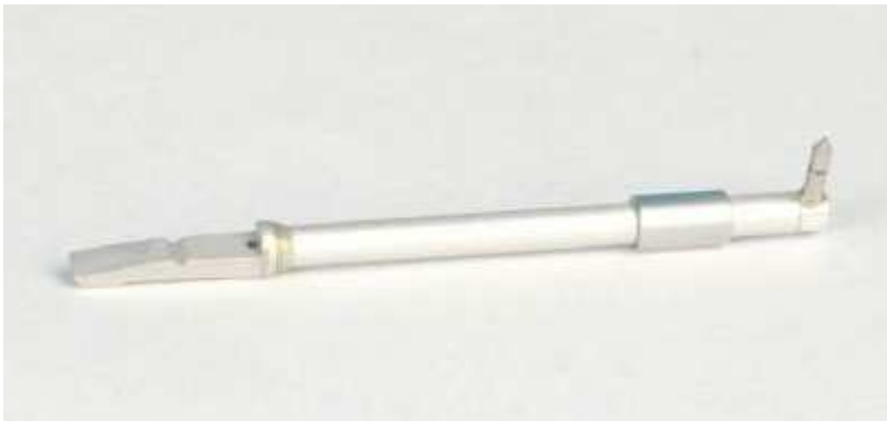
Obr. 32 Základní snímač používaný pro měření povrchu strojních součástí
