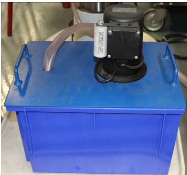
Obr. 17 Externí chlazení s čerpadlem
