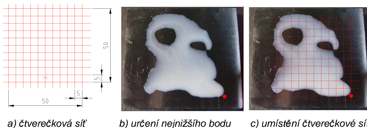
Obr. 40 Fotografie zkušebních vzorků s ulpělou procesní kapalinou
