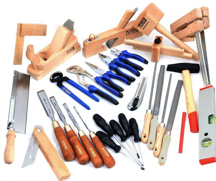
Obr. 6 Vybrané ruční nástroje pro práci se dřevem: úhelník, pilka, hoblíky, kleště, pilníky a rašple, dláta, kladivo, šroubováky, palička, rejsek, pokosník a další
