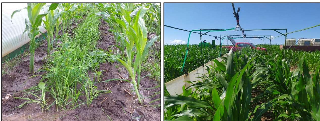
Obr. 30: Polní simulátor deště VÚMOP, v. v. i. ukázka průběhu měření na pokusných plochách
