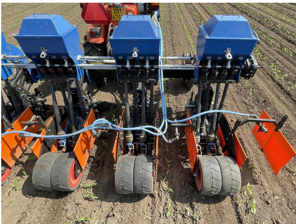
Foto 33: Detail výsevních jednotek multifunkčního testovacího stroje P & L
