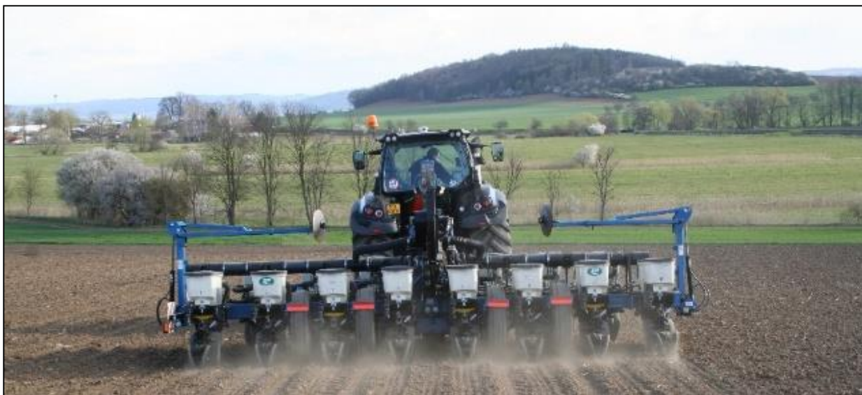
Obr. 4: Setí kukuřice secím strojem Kinze 3500 Interplant (Jevíčko, 22. 4. 2022)
