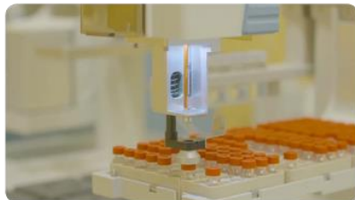
1 Nástřik vzorku na plynovou chromatografii spojenou s hmotnostní spektrometrií
