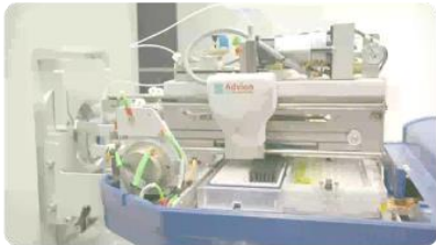
1 TriversaNanomate propojený pro přímý nástřik lipidů na hmotnostní spektrometr
