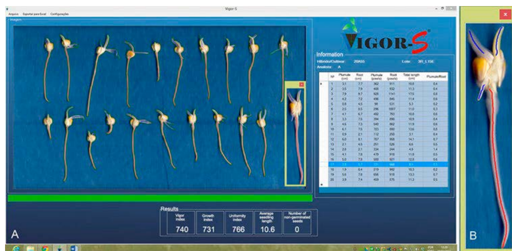
Obr. 1 Příklad využití software pro digitální analýzu obrazu pro hodnocení vitality semen (software Vigor-S). Software analyzuje, mimo jiné, délku koleoptile, délku kořenů, poměr délky koleoptile a kořenů
