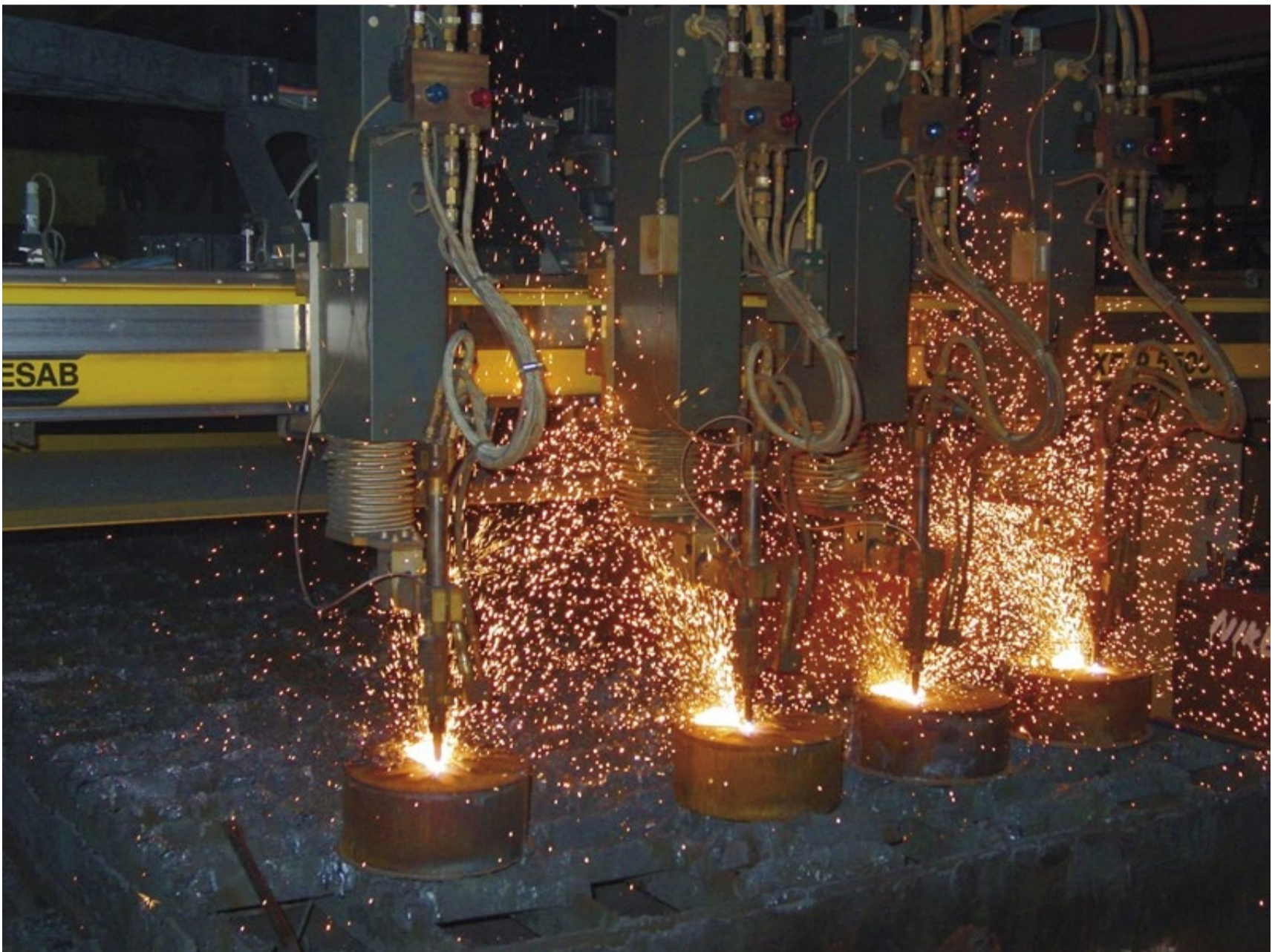
Prořezávání plechů na robotickém pracovišti pomocí směsi acetylén-kyslík, 4 hořáky.
