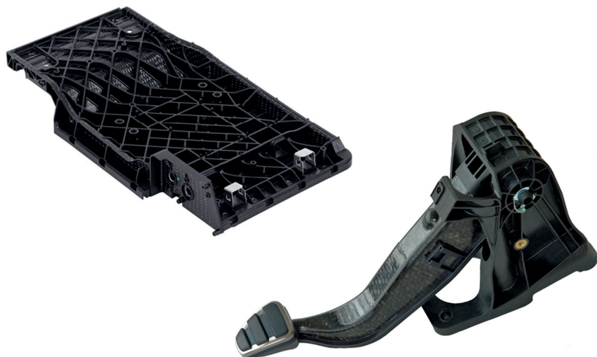
Obr. 6.26 Pevnostní díly v automobilovém průmyslu vyráběné technologií Organomelt
