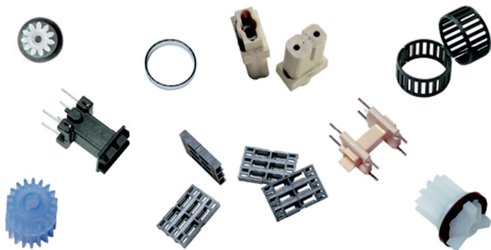
Obr. 6.11 Díly vyrobené technologií X-melt
