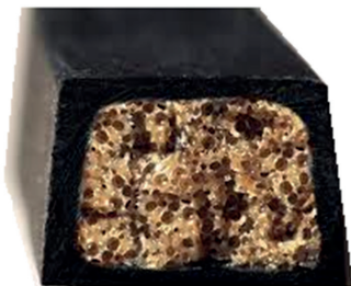
Obr. 6.19 Sendvičový díl s napěněným jádrem
