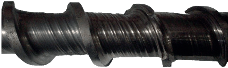
Obr. 5.10 Abrazivní opotřebení dopravní zóny diferenciálního šneku
