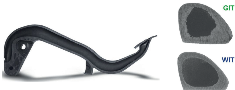
Obr. 6.8 Díl s uzavřenou vnitřní dutinou (technologie WIT) a rozdíl v kvalitě povrchu vnitřní dutiny
