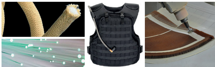
Obr. 3.4 Příklady aplikací aramidů (MPIA, PPTA) (aramidové příze se skleněnými nitěmi, optická vlákna, neprůstřelné vesty, výztuže při stavbě trupu letadel)
