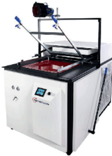
Abb. 8.5 Halbautomat mit manueller Einlegung der Platten
