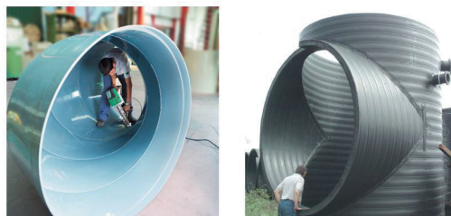
Abb. 9.24 Anwendungen des Extrusionsschweißens
