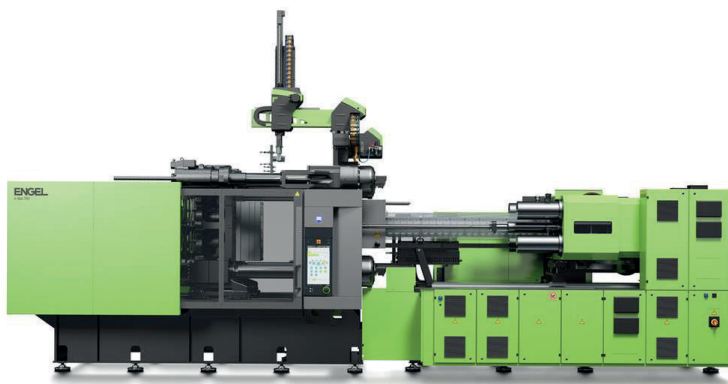
Abb. 3.15 Beispiel einer ENGEL-Spritzgießmaschine
