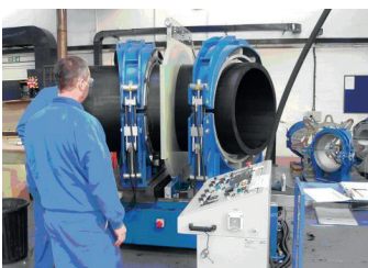
Abb. 9.5 Maschine für Stumpfschweißen von Rohren mit großen Durchschnitten
