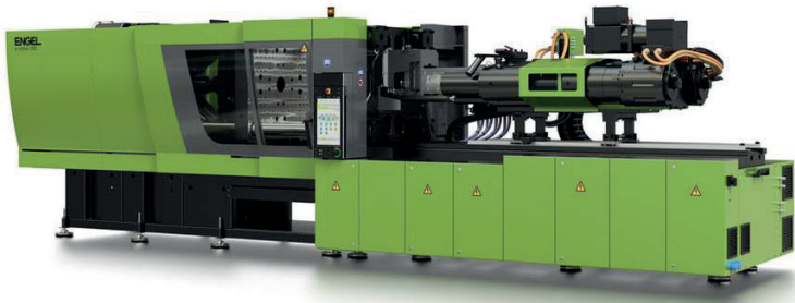
Abb. 4.19 Beispiel der Maschine für das Sandwich-Spritzgießverfahren
