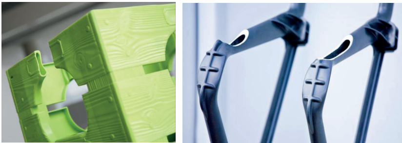
Abb. 4.11 Beispiele der Kunststoffteile, die mit GIT hergestellt sind
