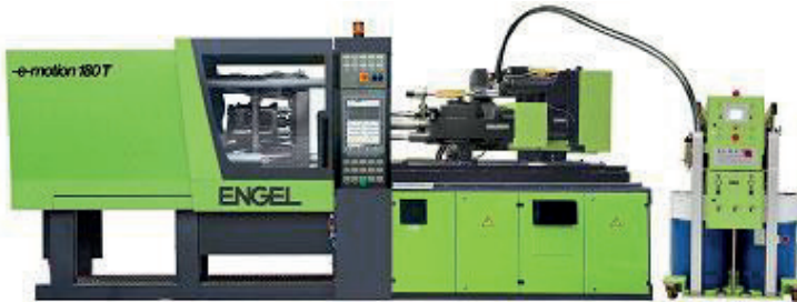
Abb. 4.8 Spritzgießmaschine für den Spritzguss von Silikonen
