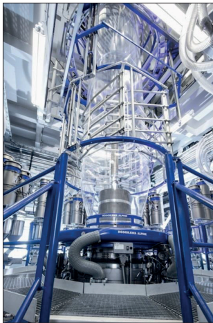
Abb. 5.22 Blasextrusion von Folien
