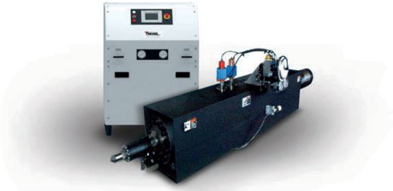
Abb. 4.48 MuCell-Spritzeinheit mit der Injektoren plus Druckregelung
