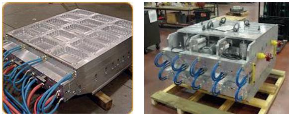
Abb. 8.3 Beispiel von Aluminiumformen mit verbundenen Kühlungs-, bzw. Temperierungskanälen
