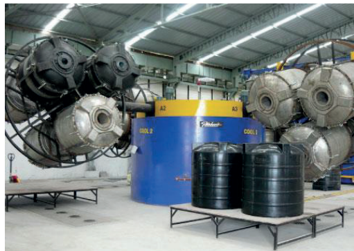
Abb. 7.3 Beispiel einer mehrachsigen Rotationsanlage
