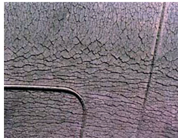
Abb. 1.17 Gummialterung durch Ozoneinwirkung
