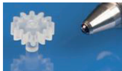
Abb. 4.57 Beispiele von Kunststoffteilen die mit dem Mikrospritzgieß-Verfahren hergestellt wurden
