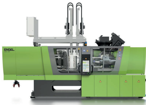
Abb. 4.4 Spritzgießmaschine für Elastomere
