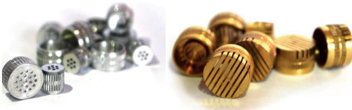
Abb. 6.6 Einleger mit Entlüftungsrillen oder -kanälen
