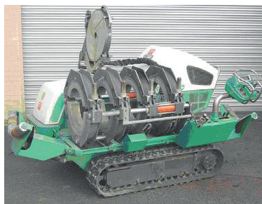
Abb. 9.4 Halbautomatische Anlage für das Stumpfschweißen
