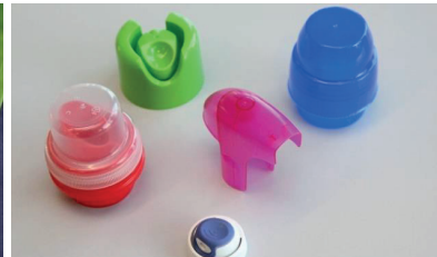
Abb. 3.1d: Beispiele der Spritzteile für die Verpackungsindustrie
