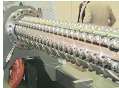
Abb. 2.4 Planetenanordnung im Rührschneckenförderer
