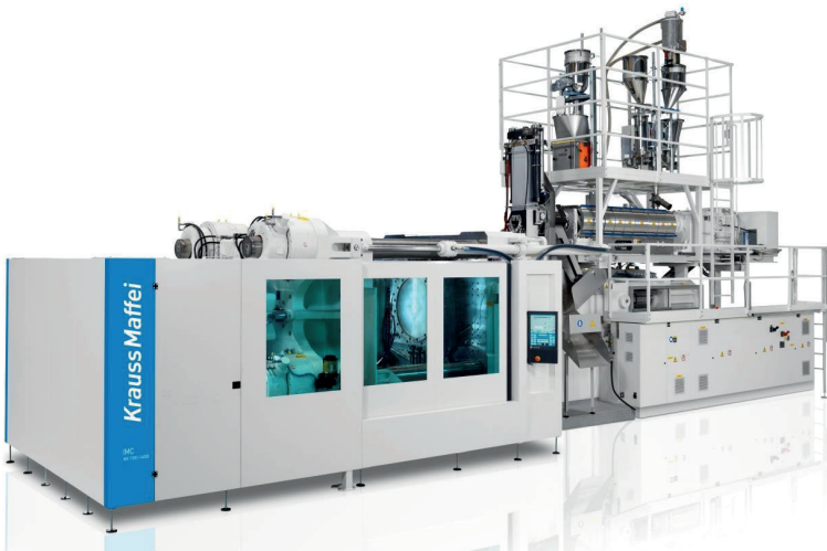
Abb. 4.60 Beispiel einer Maschine für das Spritzgießen mit Compoundierung
