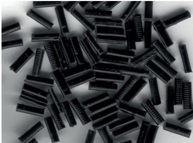
Abb. 4.10 Polymergranulat mit langen Glasfasern (LGF)
