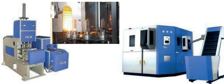
Abb. 6.11 Halbautomatische und vollautomatische Spritzblasmaschinen
