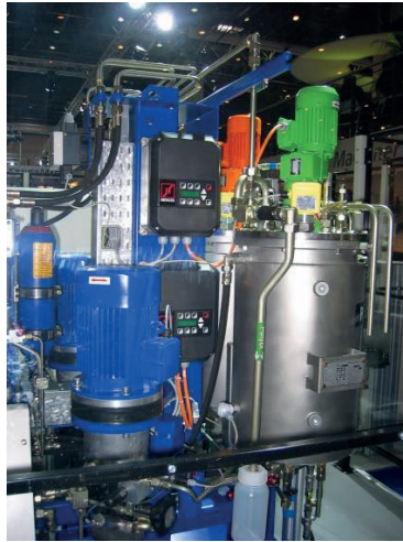
Abb. 4.38 Maschine für das RIM-Verfahren
