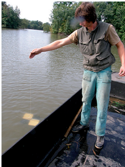
Obr. 1. Kontrola vegetačního zákalu Secchi deskou.
