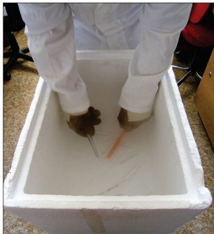
Obr. 8. Ukládání pejet do gobletů pod hladinou kapalného dusíku.
