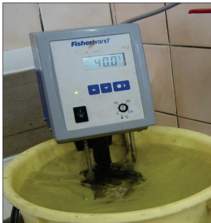
Obr. 10. Lázeň o teplotě 40 °C připravená pro rozmrazování.
