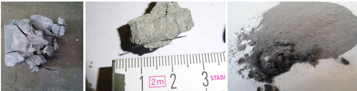
Abbildung 5: Restverbunde aus Backenbrecher (li), Restverbund aus Hammermühle (mitte), C-Faserkontaminationen im Feingut der Hammermühle (re, nach [3], MA Nazaret TU BAF 2018).
