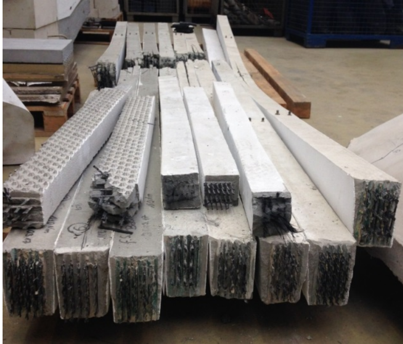
Abbildung 1: CFK-verstärkte Betonelemente aus Belastungsversuchen am BBSR Berlin.
