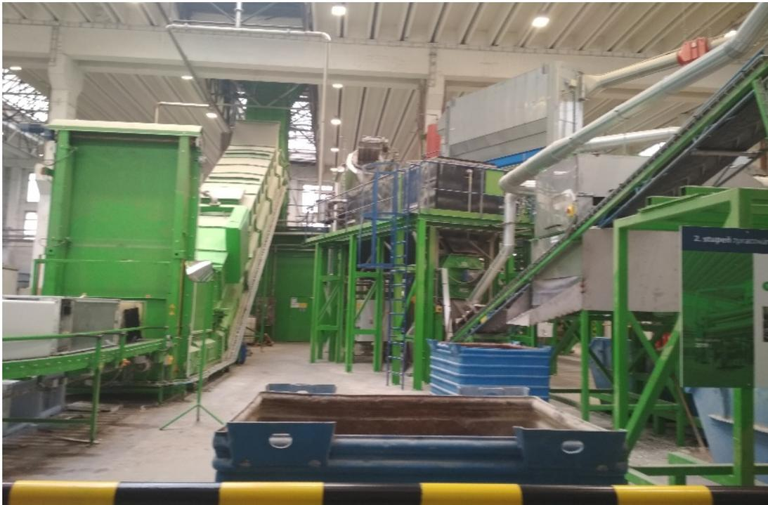
Obrázek 4: Zařízení ke zpracování EEZ (použité lednice), drcení plastů a separace kovů ve Stráži pod Ralskem; PRAKTIK Solution s.r.o.
