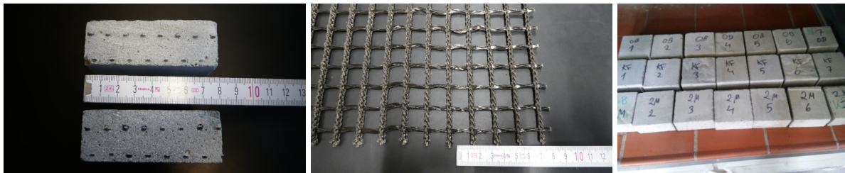
Abbildung 3: Querschnitt Betonprobekörper, Bewehrungsgewebe und Probekörperprogramm (nach MA Nazaret TU BAF 2018 [3]).
