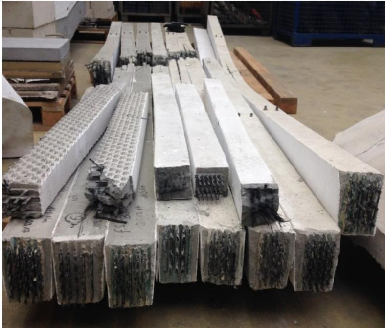
Abbildung 1: CFK-verstärkte Betonelemente aus Belastungsversuchen am BBSR Berlin.
