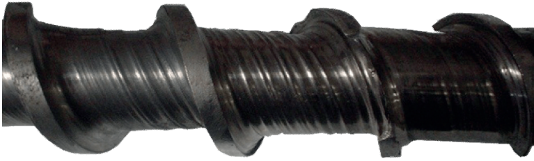
Abb. 5.10 Abrasive Abnutzung der Einzugszone der Drei-Zonen-Schnecke
