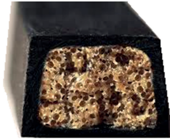
Abb. 6.19 Sandwich-Teil mit geschäumtem Kern
