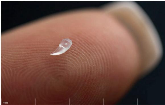
**Abb. 6.9** Mit dem Mikrospritzgießen hergestelltes Bauteil
