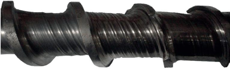
**Abb. 5.10** Abrasive Abnutzung der Einzugszone der Drei-Zonen-Schnecke
