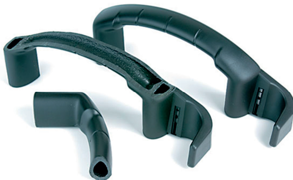
Abb. 6.7 Werkstück mit einem geschlossenen Hohlraum (GIT-Spritzgussverfahren)
