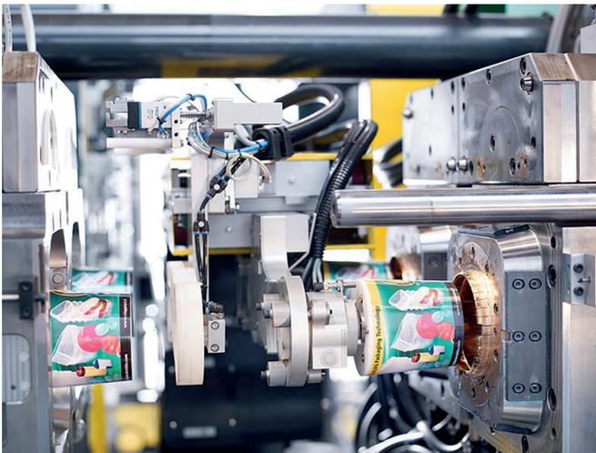
**Abb. 6.21** Einlegen der Etikette in die Kavität des Spritzgießwerkzeugs
