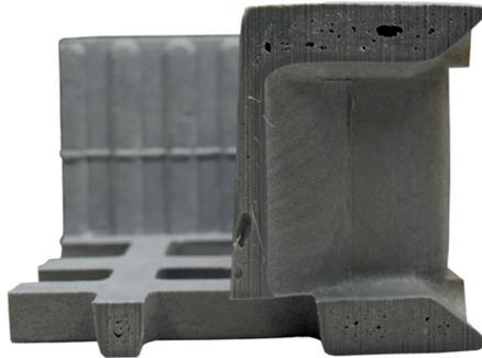
**Abb. 6.1** Schnitt durch ein geschäumtes Bauteil
