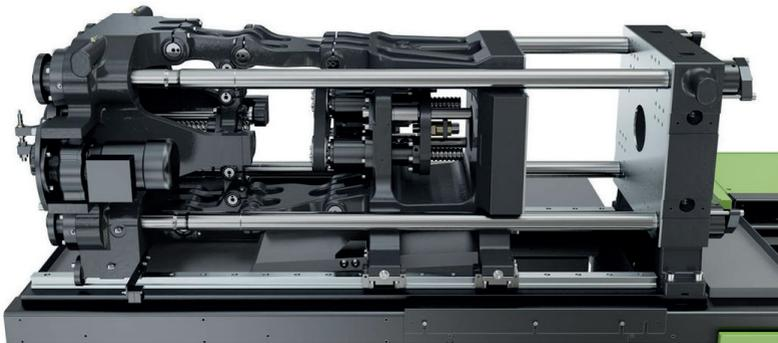
**Abb. 5.12** Kniehebel-Mechanismus-Schließeinheit
