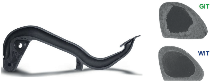
Abb. 6.8 Werkstück mit einem geschlossenen Hohlraum (WIT-Spritzgussverfahren) und der Qualitätsunterschied in der Oberfläche des Hohlraums
