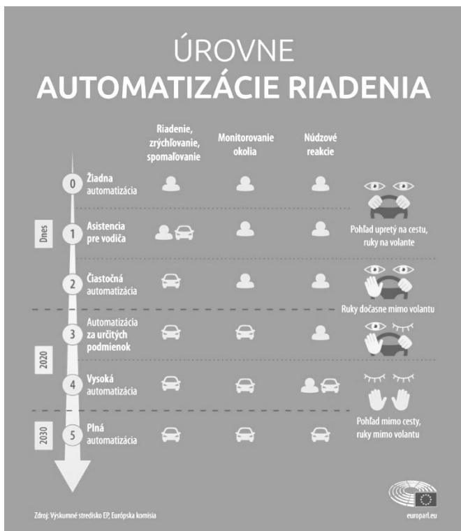
Obr. 7. Úrovně automatizovaného riadenia vozidla [12]
