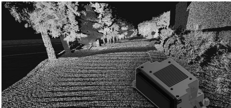
Obr. 29. Mračno bodov vytvorené 3D Lidarom [19]
