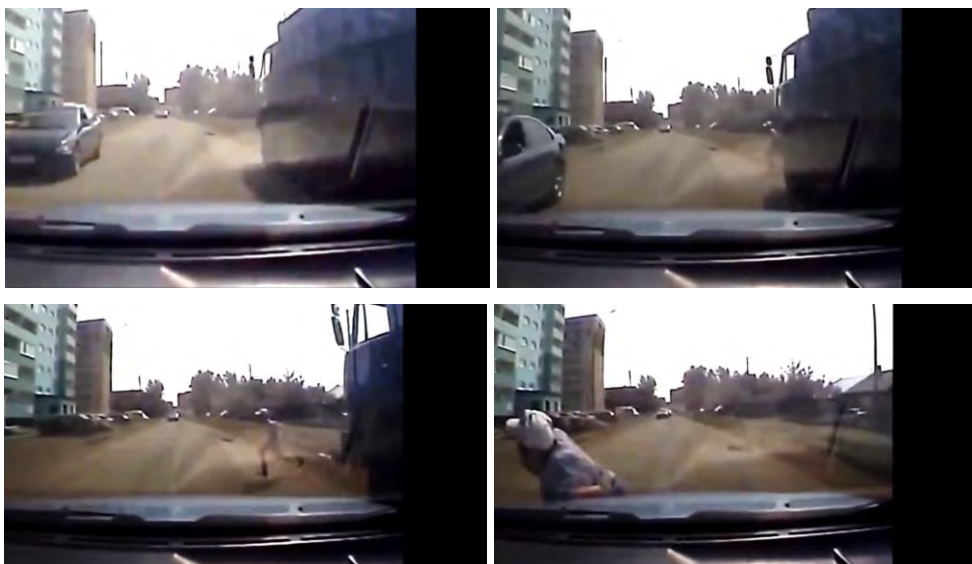
Obr. 40. Chodec je za stojacim vozidlom (vľavo hore). Chodec vybieha spoza vozidla (vpravo hore). Chodec vbehol do koridoru jazdy vozidla (vľavo dole). Zrážka chodca s vozidlom rýchlosťou cca 40 km/h (vpravo dole). [14]
