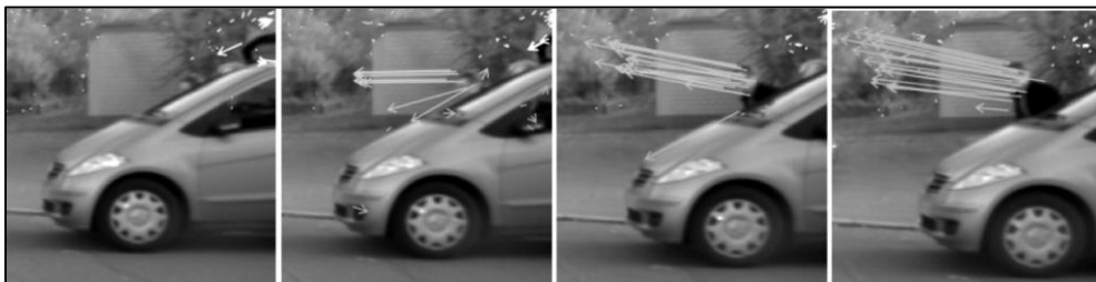
Obr. 22. Příklad trakovania pohybu chodca pomocou stereokamery [25]
