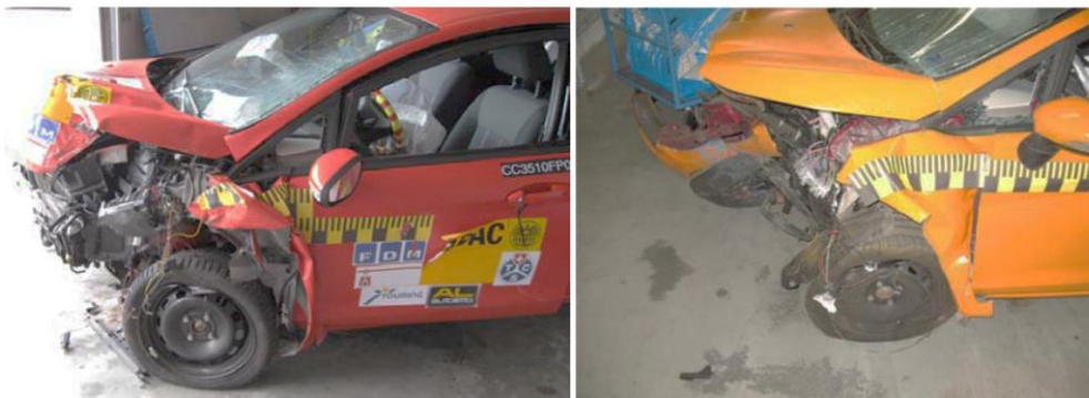
Obr. 68 Porovnanie deformácie vozidla pri náraze do bariéry (vľavo) a pri náraze do iného vozidla (vpravo) [43]
