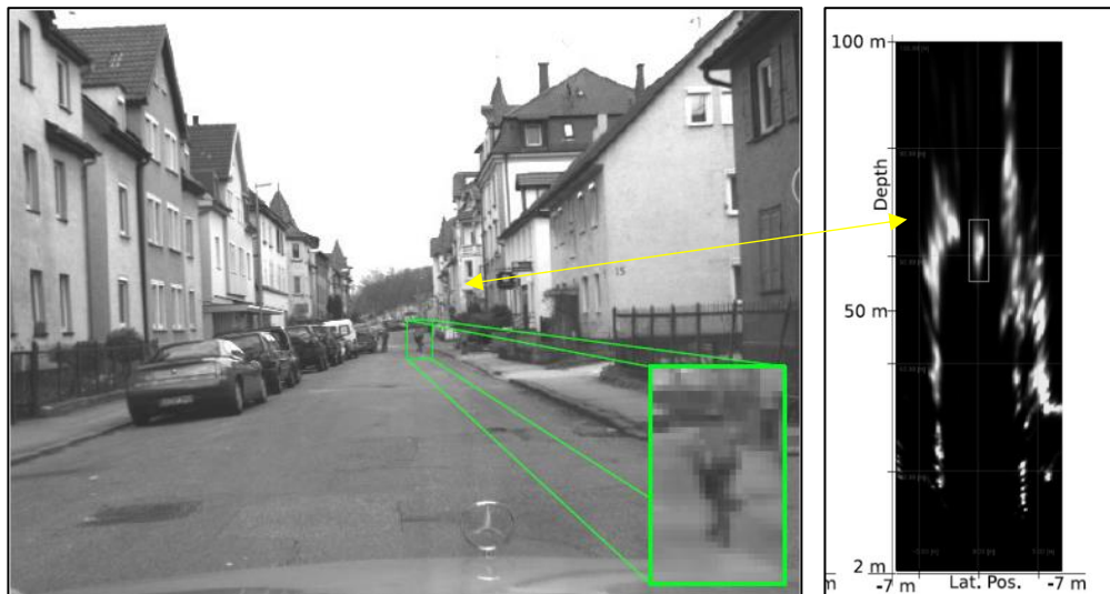
Obr. 20 Prevod obrazu do karteziánskeho súradnicového systému [21]
