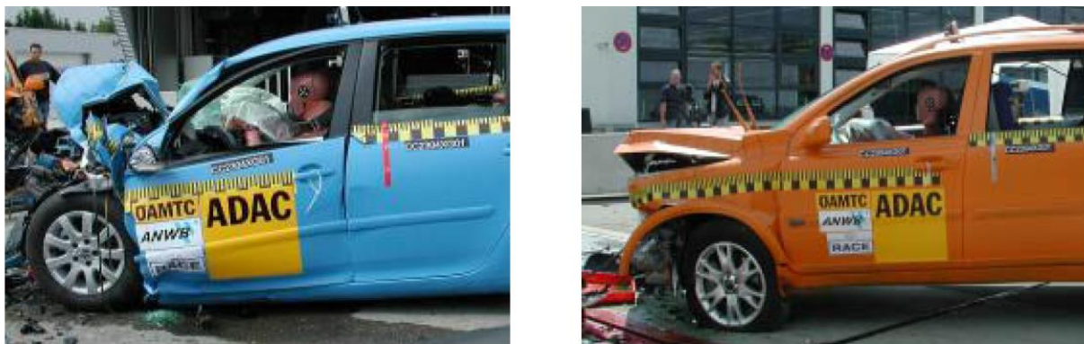
Obr. 66 Porovnanie podobných vozidiel s rôznou tuhosťou [43]
