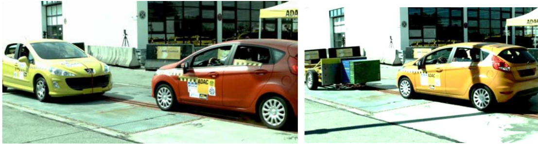
Obr. 67 Záber na test auto verzus auto (vľavo). Záber na test auto verzus maketa (vpravo) [43]
