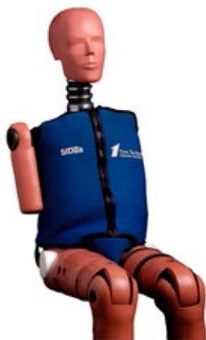
Obr. 69 Prehľad dummy figurín dospelého človeka na testy čelného nárazu vozidla [34]
