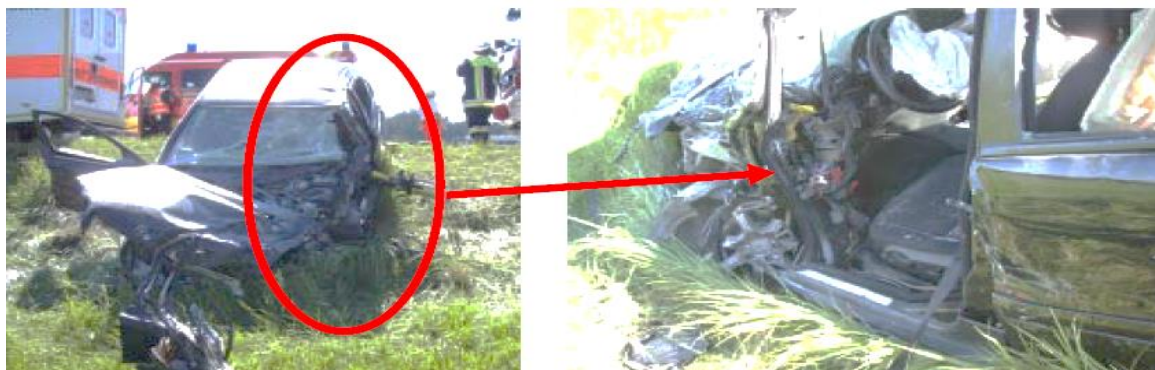
Obr. 64 Deformácia vozidla po náraze na pozdĺžny nosník [43]
