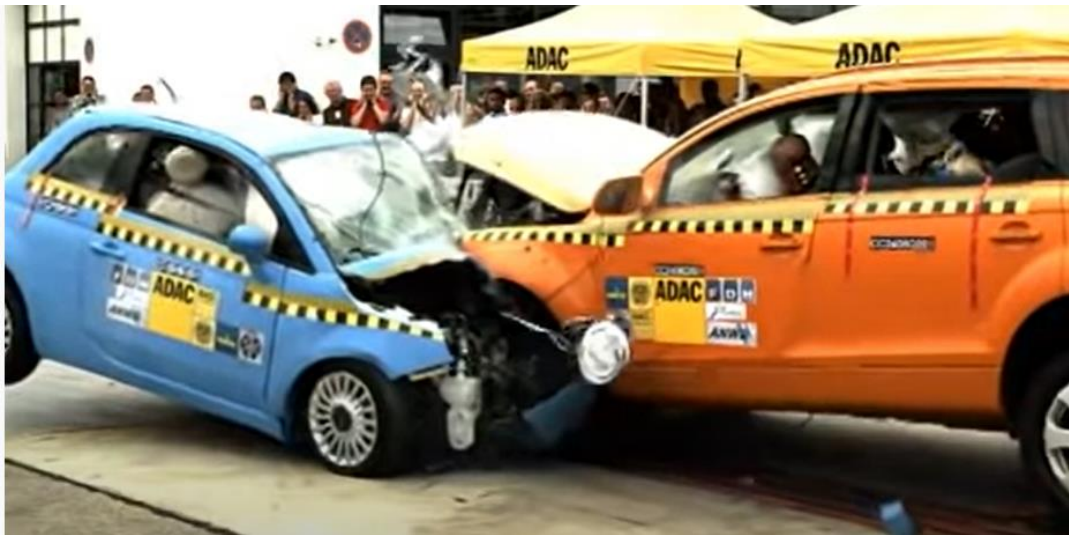
Obr. 65 Zrážka vozidla Fiat 500 a Audi Q7 [44]
