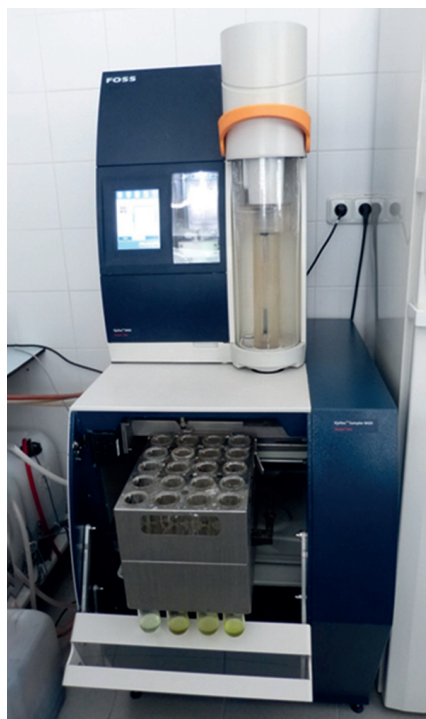
Obr. 10. Destilace a titrace mineralizátů vzorků filet na přístroji KJELTEC 8400 s KJELTEC sampler 8420, stanovení bílkovin (Foto: L. Schebestová).
