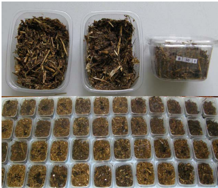
Obř. 3. Nahoře 250ml PP potravinářské krabičky použité v testu akutní toxicity čerstvých kalů z RAS na násadu žížal E. andrei , zde konkrétně tři opakovaní varianty s 50 % sušiny kalu z biofiltru. Dole série substrátů na počátku testu (Foto: A. Kouba).
