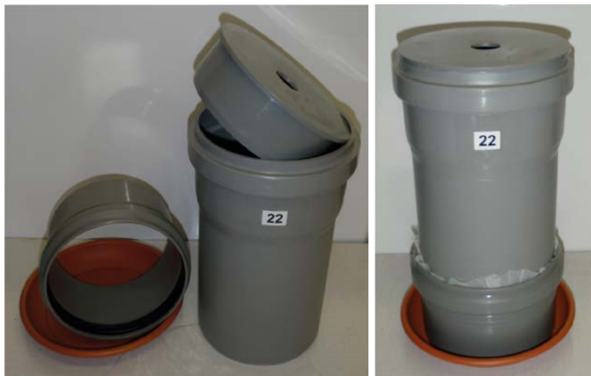
Obr. 1. Rozložený (vlevo) a složený (vpravo) trubkový inkubátor využívaný během testování. Patrná je přítomnost uhelonu upevněného ve spodní části složeného inkubátoru (Foto: A. Kouba).
