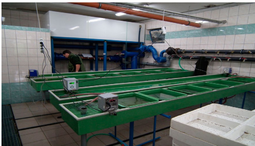
Obr. 2. Sestava inkubačních žlabů na Pstruhařství ČRS Kaplice, spol. s r.o. Vzadu a vpředu žlaby temperované na 10 °C na inkubaci jiker do začátku šoku a na předeřtání vody k aktivaci gamet; druhý žlab vpředu temperovaný na 26,5 °C k realizaci teplého šoku. Červené hadice vedou od akvarijních čerpadel a zajišťují cirkulaci temperované vody. Foto M. Kříž.
