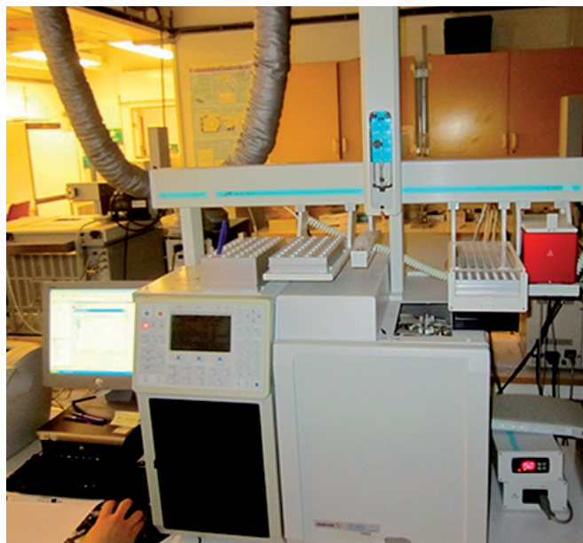
Obr. 10. Plynový chromatograf Varian CP 3800 určený ke zjištění kompozice mastných kyselin.
