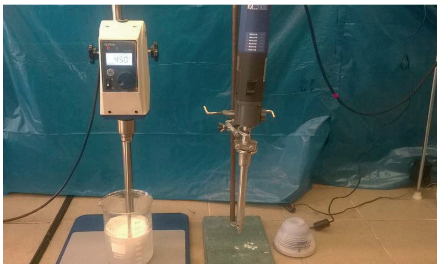
Obr. 6. Přístrojové vybavení nezbytné pro přípravu PLGA mikročastic z násobné emulze metodou odpaření rozpouštědla; zleva: hřídelové míchadlo, homogenizátor, vortex (Foto: J. Vysloužil).
