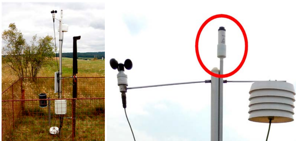
Obr. 40 Meteorologická stanice v biologickém experimentu, včetně senzoru pro měření intenzity slunečního záření (vlevo), detail senzoru pro měření intenzity slunečního záření (vpravo)
