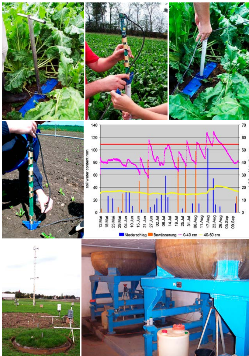
Obr. 9 Příprava a instalace systému pro monitoring vlhkosti půdy v porostu řepy cukrové (senzor EasyAG) – nahoře. S použitím půdního vrtáku umožňuje systém monitoring v prakticky nepoškozeném půdním profilu. Příprava systému pro řízení polních závlah (vlevo uprostřed); vpravo uprostřed – řízení polní závlahy automatickým systémem monitorujícím vlhkost půdy ve dvou hloubkových úrovních (žlutá a fialová křivka, srážky – modré sloupce a množství závlahové vody – oranžové sloupce) během vegetační sezóny (Rakousko). Horizontální čáry (modrá a oranžová) zachycují půdní hydrolimity půdy na půdním bloku. Vlevo dole – lyzimetrická stanice v Groß Enzersdorf (Rakousko), vpravo dole – zázemí lyzimetru (šachta pod lyzimetru s vážícím zařízením a jímáním průsakové vody).
