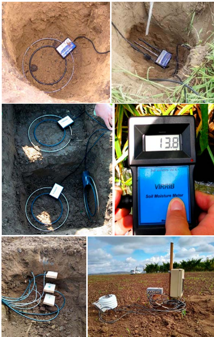
Obr. 8 Vodorovné umístění snímačů pro monitoring půdní vlhkosti – čidlo VIRRIB (snímek vlevo nahoře); vodorovné umístění snímačů pro monitoring půdní vlhkosti – čidlo VIIRB – minimalizovaný typ (snímek vpravo nahoře); kombinace svislého a vodorovného umístění snímačů vlhkosti půdy VIRRIB (snímek vlevo uprostřed); manuální odečet údajů snímačů VIRRIB (snímek vpravo uprostřed); na dolním levém snímku: čidlo na měření půdní vlhkosti CS650 – vodorovně zasunuté břity (s bílou vyhodnocovací jednotkou) v pravé části snímku, půdní teploměry v levé části snímku; na dolním pravém snímku: ústředny senzorů VIRRIB a čidel CS650 s rozhraním pro odečet dat prostřednictvím kabelu a notebooku, případně s možností dálkového přenosu dat
