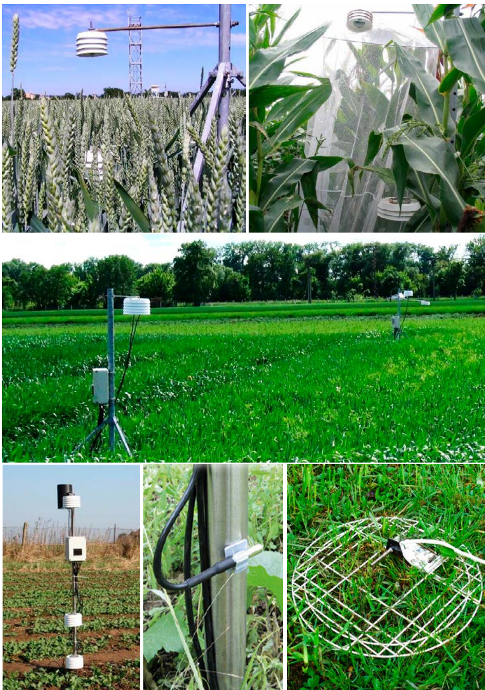
Obr. 17 Různé typy čidel pro měření teploty vzduchu umístěné v radiačních stínítkách; monitoring v různých zemědělských experimentech; dole vlevo – varianta monitoringu přízemní teploty vzduchu – monitoring v radiačním stínítku, dole uprostřed a vpravo – varianta monitoringu minimální přízemní teploty vzduchu – monitoring nestíněným čidlem
