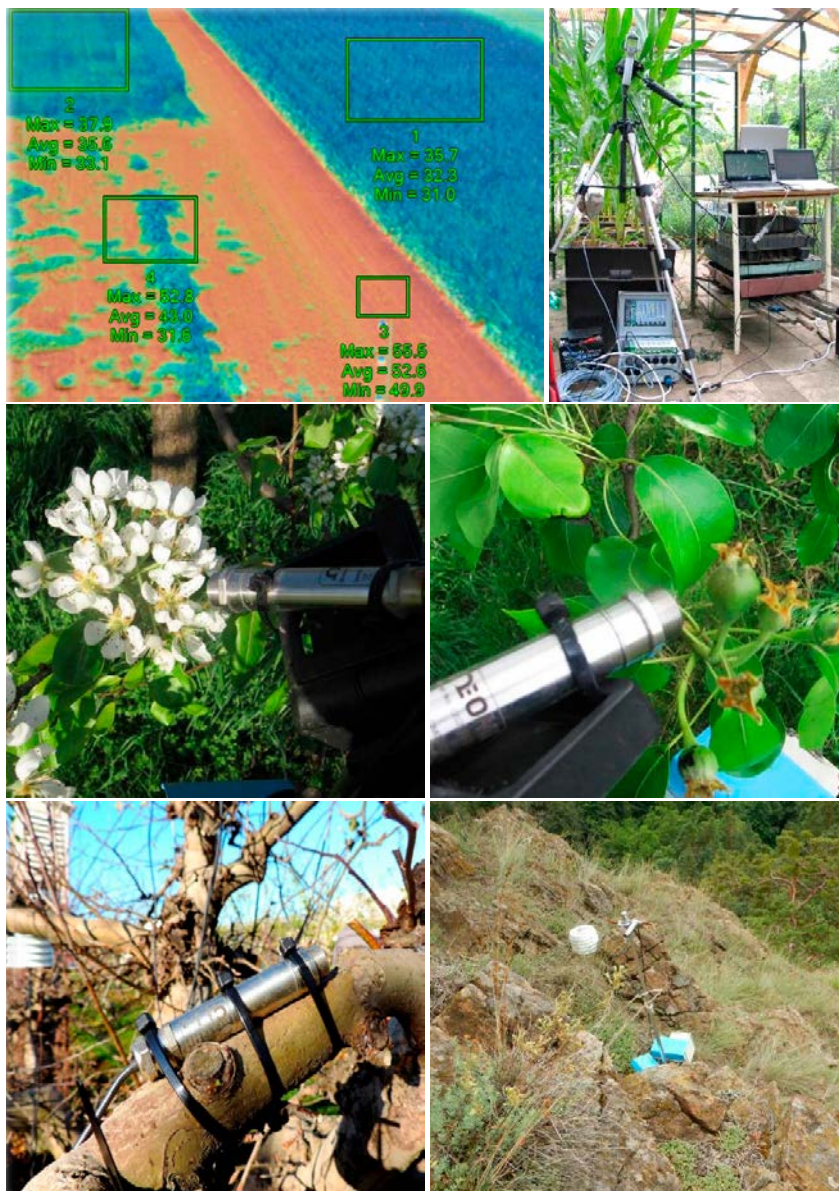
Obr. 22 Monitoring teploty povrchů v biologických experimentech použitím techniky různé konstrukce; povrchová teplota heterogenního povrchu pole s různými plodinami – termosnímek pořízený termální kamerou (nahore vlevo); měření povrchové teploty listů kukuřice infračerveným bezdotykovým termometrem (nahore vpravo); dlouhodobé měření povrchové teploty rostlinných pletiv infračerveným bezdotykovým teploměrem (uprostřed vlevo měření teploty květů, uprostřed vpravo měření teploty plodů, dole vlevo měření teploty povrchu kůry ovocného stromu); dlouhodobé měření povrchové teploty přírodních povrchů v přírodně cenném prostředí (dole vpravo)
